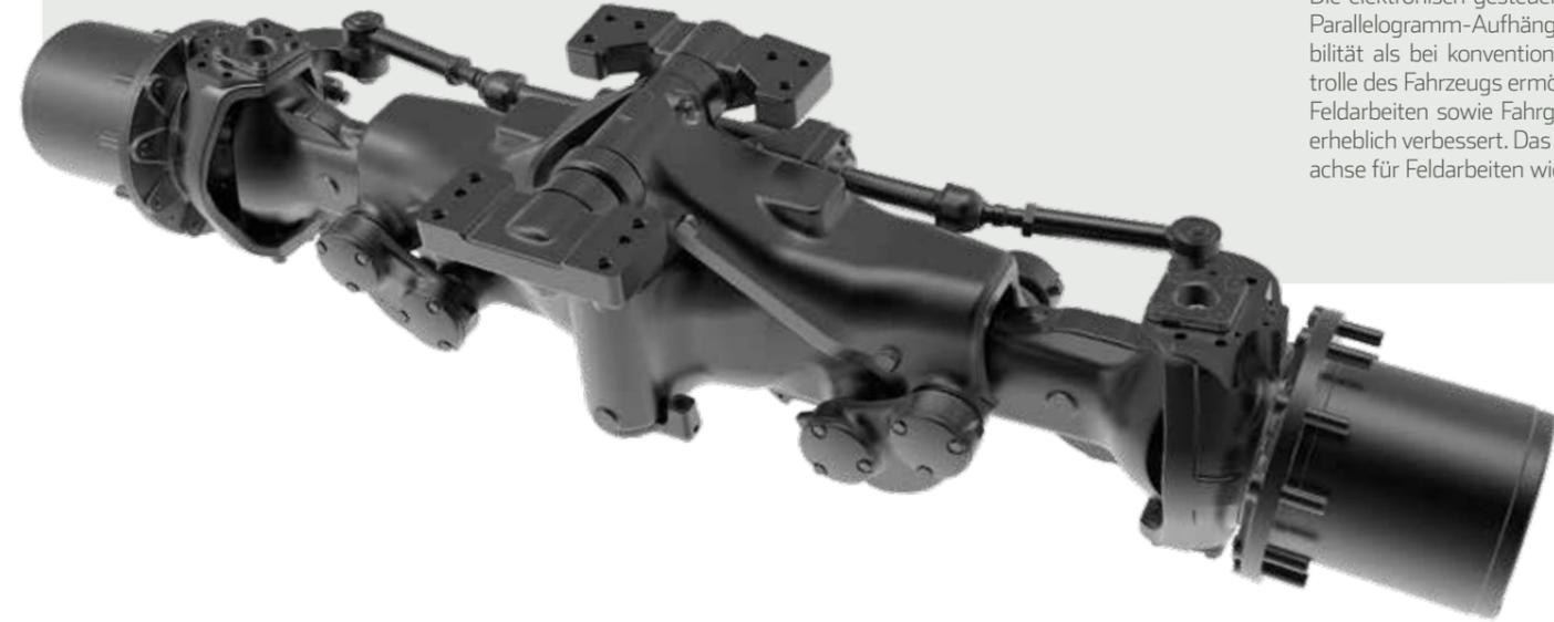
**VORDERACHSE MIT PARALLELOGRAMM-AUFHÄNGUNG FÜR VERBESSERTE LEISTUNG**
