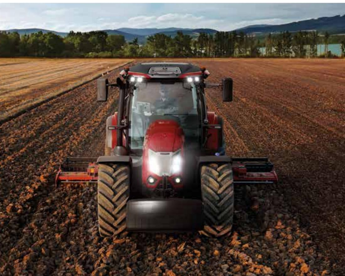
El **X8** equipa los nuevos motores FPT N67 de 6,7 litros con 6 cilindros y 24 válvulas, turbocompresor, intercooler e inyección electrónica Common Rail. El turbocompresor de geometría variable eVGT garantiza una respuesta instantánea a las variaciones de carga. El par máximo de 1282 Nm está disponible a partir de 1400 rpm y se mantiene constante hasta 1800 rpm, con una reserva de par de hasta el 40%.
