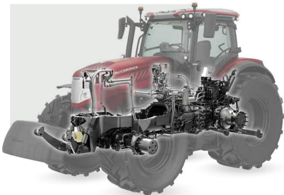
L'impianto idraulico dell'X8 è a centro chiuso con pompa a portata variabile: in base al carico, regola il flusso dell'olio verso i distributori, per evitare gli assorbimenti inutili di potenza e quindi per avere sempre il massimo delle prestazioni. Il circuito invia 212 l/min al sollevatore e ai distributori, e 115 l/min allo sterzo e ai servizi a bassa pressione, permettendo un uso anche simultaneo di tutte le attrezzature idrauliche.
