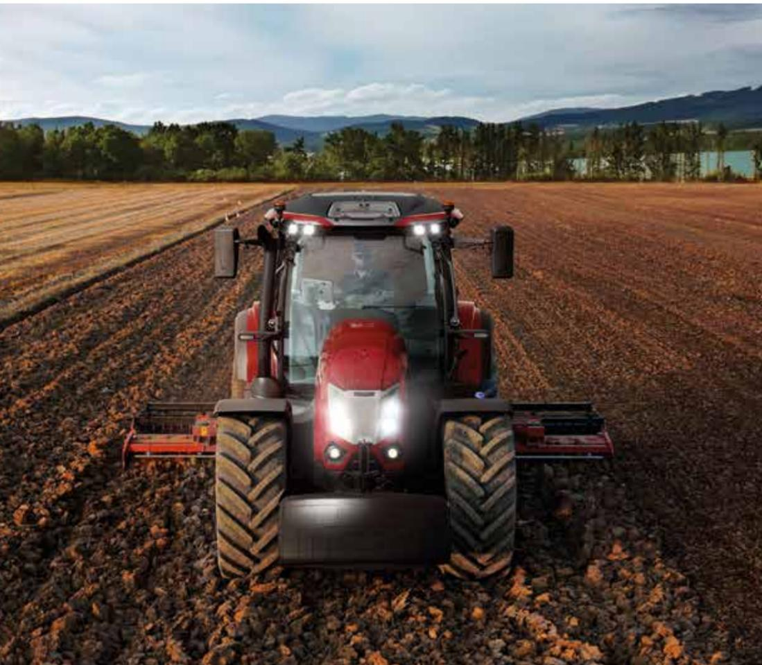
L'X8 è equipaggiato con i nuovi propulsori FPT N67, da 6,7 litri, 6 cilindri, 24 valvole, intercooler e iniezione elettronica common rail. Il suo turbocompressore eVGT a geometria variabile assicura prestazioni sempre reattive, anche con aumenti di carico. La coppia massima di 1.282 Nm è disponibile a soli 1.400 giri/min ed è costante fino a 1.800 giri/min, con una eccellente riserva di coppia che arriva fino al 40 %.
