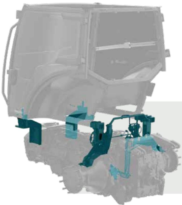
Con la nuova Clever Cab lo spazio si è espanso. L'intelligente design del telaio a 4 montanti ha incrementato la superficie vetrata del 14%, per consentire una completa visuale panoramica su tutta l'area di lavoro e sugli attrezzi. Anche lo spazio interno è aumentato, in particolare nell'area attorno al busto e alla testa del professionista, con 8 cm in più in altezza. La corsa del sedile è stata estesa di 12 cm. Le aree portaoggetti sono tutte integrate, per non invadere lo spazio operativo.
