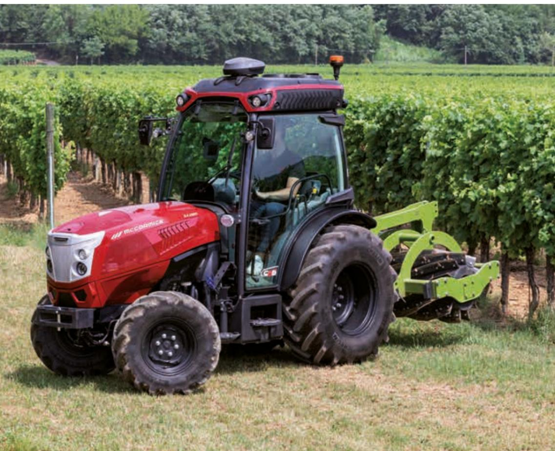
La transmisión Speed Four del **X4F** presenta: 4 marchas sincronizadas y 3 gamas mecánicas, con un total de 12 AD + 12 MA. Con el superreductor, las gamas se convierten en 4, con un total de 16 AD + 16 MA. La transmisión Speed Four permite varias configuraciones:
