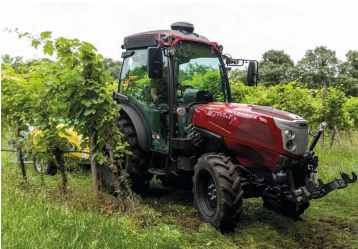
Los modelos F, N y XL pueden equiparse con un eje delantero suspendido, para aumentar la estabilidad y agilidad. El eje suspendido garantiza al **X4F** la máxima adherencia al suelo, incluso en terrenos abruptos. En el campo, mejora tanto la tracción como el control del tractor, mientras que, en los desplazamientos, aumenta la seguridad, la velocidad y el confort.
