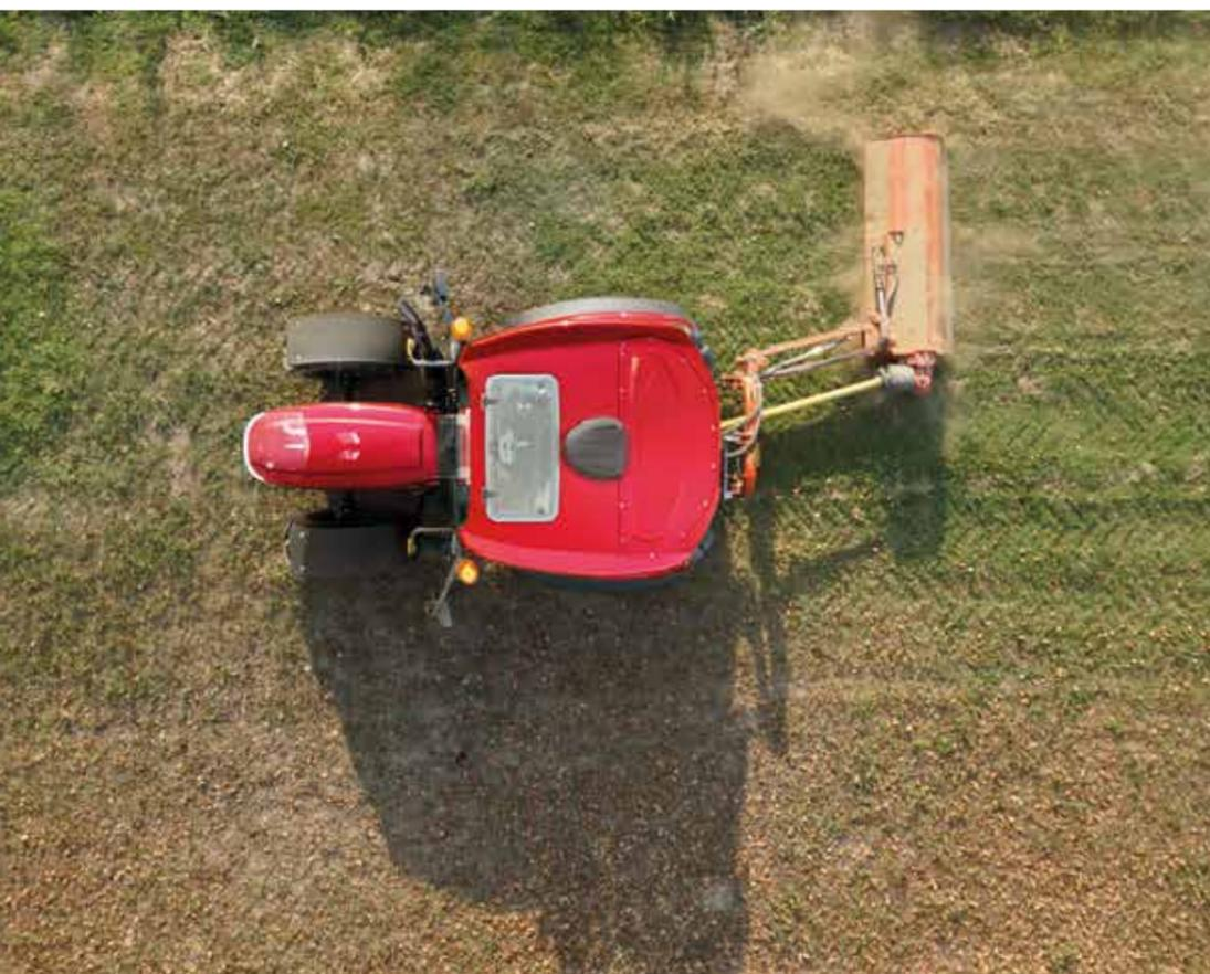
**Le X6 est idéal pour ceux qui veulent moins de compactage du sol.** Pendant le travail au champ, le tracteur X6 assure un faible compactage du sol grâce à un large choix de pneus et à une répartition optimale des masses de respectivement 45% sur l'essieu avant et 55% sur l'essieu arrière. Le tracteur X6 offre la meilleure répartition des masses dans sa classe de puissance.
