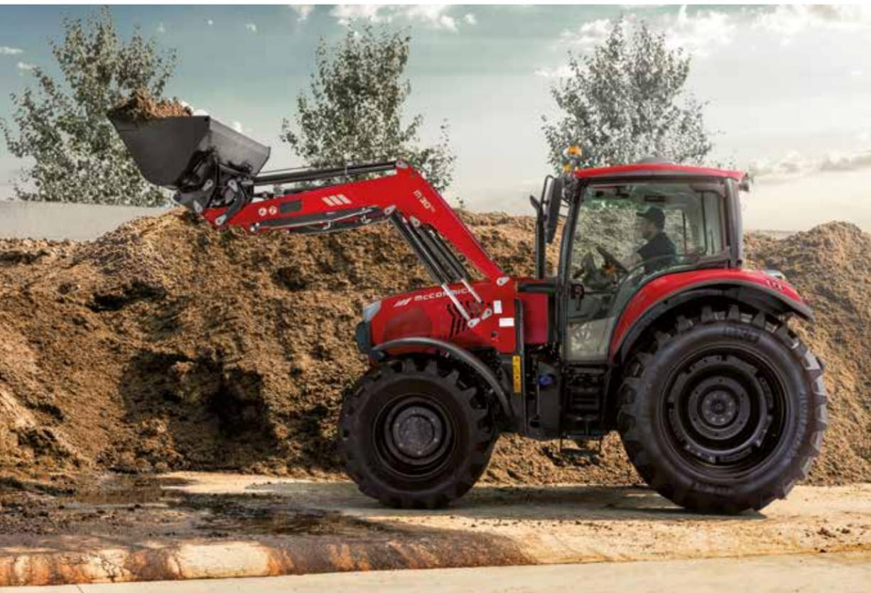
Le chargeur frontal M30 de McCormick est spécialement conçu pour être installés sur le tracteur **X6**. Il est fabriqué en acier HLE à haute limite d'élasticité, un matériau capable de résister à des charges très élevées. Le chargeur est commandé intuitivement par le joystick multifonction. Le chargeur M30 se caractérise par les points forts suivants :
