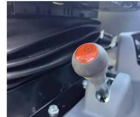
Avec les vitesses rampantes, la transmission électrohydraulique XtraShift permet d'obtenir au total 48 vitesses avant et 16 vitesses arrière. Grâce à des rapports bien étagés, le **X6** répond au mieux aux besoins spécifiques de chaque exploitation agricole. La vitesse minimale de 309 m/h assure une grande efficacité dans toutes les applications, tandis que la vitesse maximale de 50 km/h rend le tracteur rapide et sûr lors des déplacements sur route.
