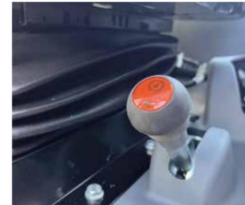
Mit dem Kriechgang bietet das XtraShift-Getriebe 40 Vorwärts- und 16 Rückwärtsgänge. Dank der guten Gangabstufung entspricht der X6 optimal den speziellen Anforderungen jedes landwirtschaftlichen Betriebs. Die Mindestgeschwindigkeit von 309 m/h garantiert maximale Effizienz bei Feldarbeiten, während die Höchstgeschwindigkeit von 50 km/h den X6 schnell und sicher bei Straßenfahrten macht.
