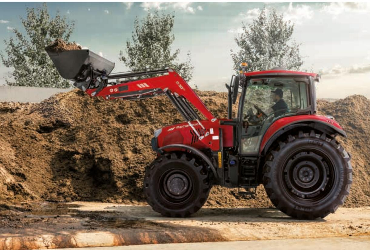
Der Frontlader M30 ist perfekt auf den Traktor **X6** abgestimmt. Er ist aus HLE-Stahl (hohe Elastizitätsgrenze) hergestellt, einem Material, das aufgrund seiner mechanischen Eigenschaften hohen Belastungen standhält. Die Stärke des Frontladers M30 sind folgende:
