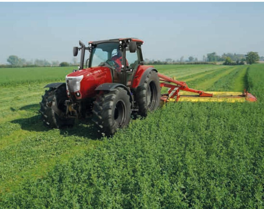
Gracias al sistema hidráulico CCLS, Centro Cerrado Load Sensing, con bomba de caudal variable, el aceite se regula en función de la carga. Una tecnología que elimina las pérdidas de potencia inútiles, reduce el ruido y el consumo, y aumenta las prestaciones. El circuito de 114 l/min para la dirección, el elevador y los distribuidores permite usar los aperos delanteros y traseros a la vez.
