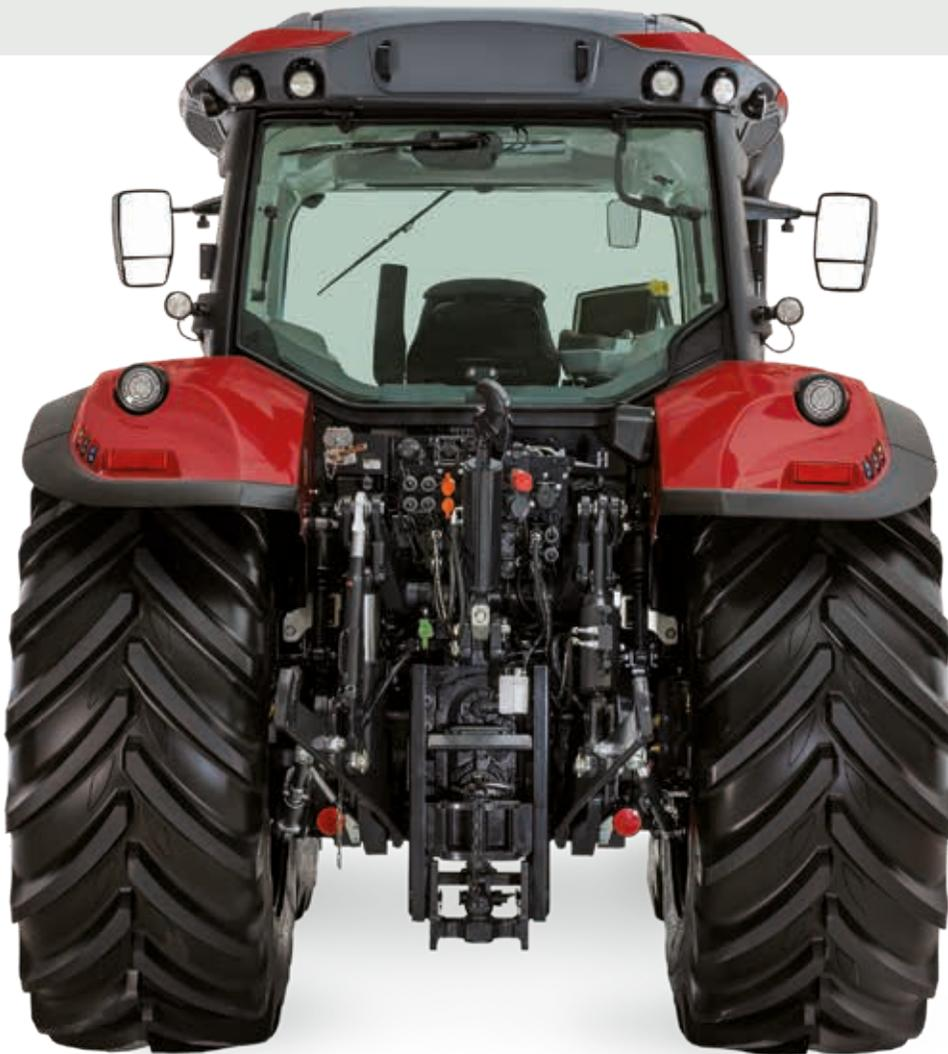
McCormick **X7 SWB** dispone de un circuito hidráulico CCLS – Centro Cerrado Load Sensing, con bomba de caudal variable, para regular el flujo del aceite en función de la carga. Esta tecnología elimina toda la absorción de potencia inútil, para asegurar las máximas prestaciones en todo momento. El circuito suministra hasta 160 l/min al elevador y a los distribuidores, permitiendo un uso simultáneo de las funciones hidráulicas. La bomba dedicada a la dirección tiene un caudal de 52 l/min.
