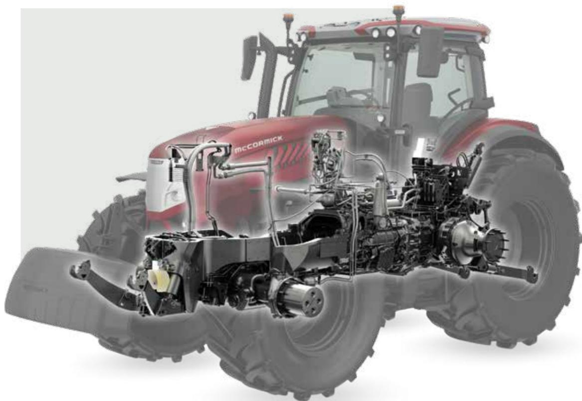
L'impianto idraulico dell'X8 è a centro chiuso con pompa a portata variabile: in base al carico, regola il flusso dell'olio verso i distributori, per evitare gli assorbimenti inutili di potenza e quindi per avere sempre il massimo delle prestazioni. Il circuito invia 160 l/min al sollevatore e ai distributori, e 115 l/min allo sterzo elettronico, consentendo così un uso anche simultaneo di tutte le attrezzature idrauliche. È disponibile anche una pompa con portata maggiorata da 212 l/min.
