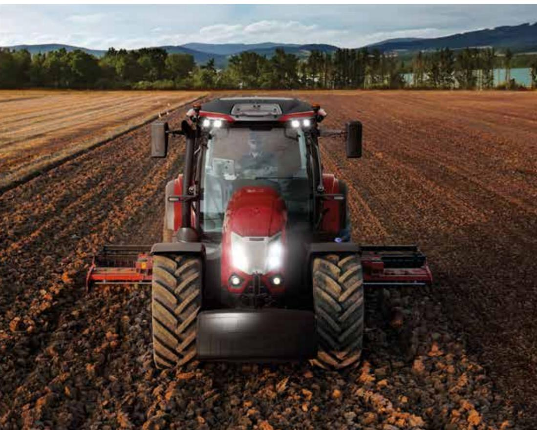
L'X8 è equipaggiato con i nuovi propulsori FPT NEF 67, da 6,7 litri, 6 cilindri, 24 valvole, Intercooler e iniezione elettronica Common Rail. Il suo turbocompressore eVGT a geometria variabile assicura prestazioni sempre reattive, anche con aumenti di carico. La coppia massima è disponibile a soli 1.400 giri/min. Il sistema di trattamento dei gas di scarico HI-eSCR2 rispetta la normativa antinquinamento Stage V.
