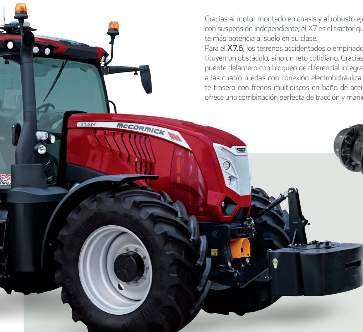
Gracias al motor montado en chasis y al robusto eje delantero con suspensión independiente, el X7 es el tractor que transmite más potencia al suelo en su clase.
