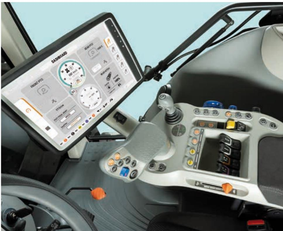
La gamma **X7 SWB** è allestita con la spaziosa e comoda Première Cab. Questa cabina di nuova ideazione, grazie alla sua struttura a 4 montanti, assicura una piena visibilità a 360° che riduce la necessità di muoversi per controllare gli angoli ciechi. Le porte incernierate posteriormente aumentano ancora di più la visibilità. L'ottimo livello di insonorizzazione, fino a 70 dB, crea un ambiente lavorativo di grande comfort.
