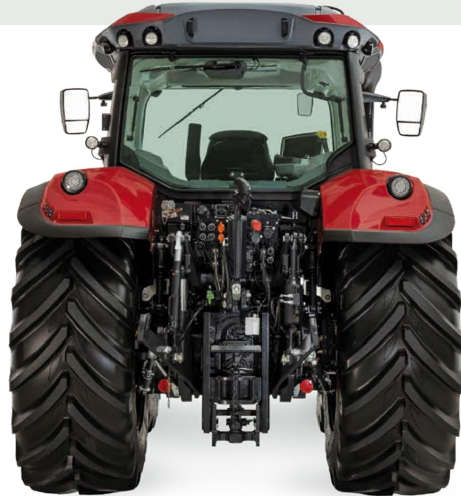
McCormick X7 SWB dispone di un impianto idraulico CCLS – Centro Chiuso Load Sensing, con pompa a portata variabile, per regolare il flusso dell'olio in funzione del carico. Questa tecnologia elimina ogni inutile assorbimento di potenza, per assicurare prestazioni sempre al top. Il circuito invia fino a 160 l/min al sollevatore e ai distributori, permettendo un uso simultaneo delle attrezzature idrauliche. La pompa dedicata allo sterzo ha una portata di 52 l/min.
