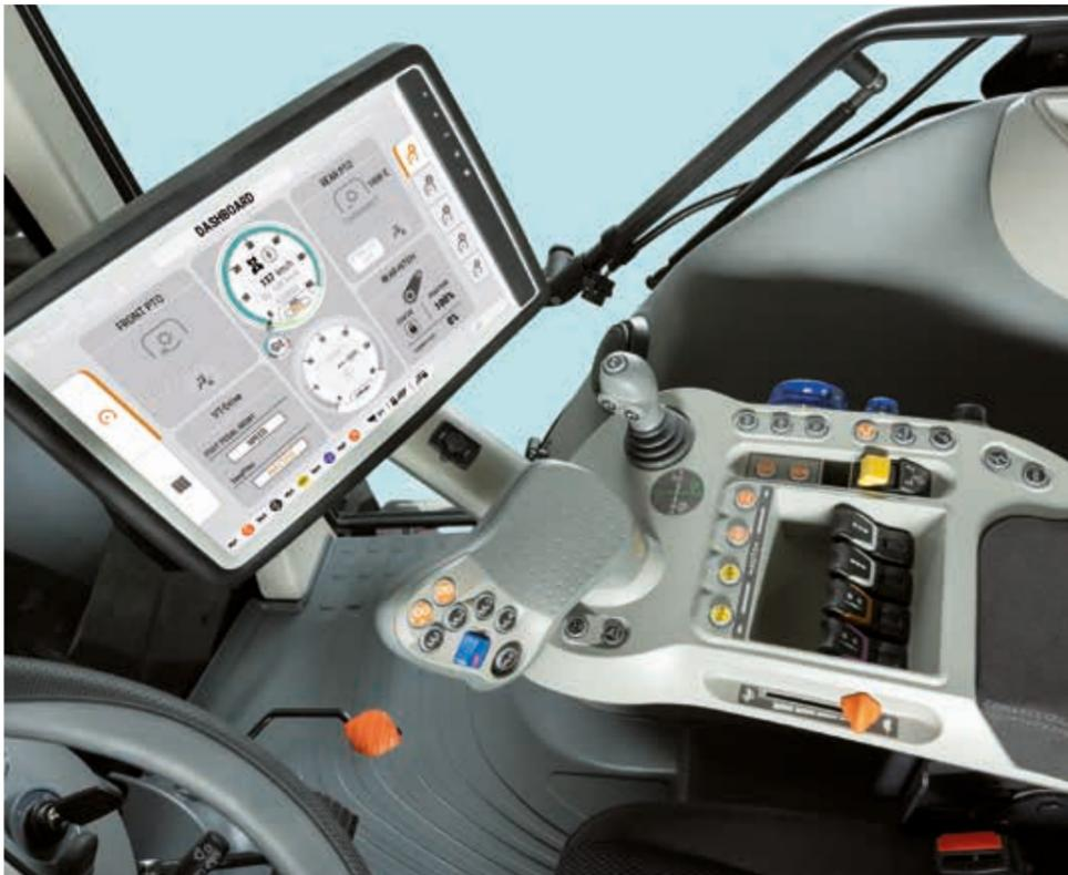
La gama **X7 SWB** está equipada con la Première Cab cómoda y amplia. Gracias a su estructura de 4 montantes, esta cabina de nuevo diseño, asegura una visibilidad total de 360° que reduce la necesidad de moverse para controlar los puntos ciegos. Las puertas ancladas en el montante trasero aumentan aun más la visibilidad. La excelente insonorización de hasta 70 dB, crea un entorno de trabajo muy cómodo.
