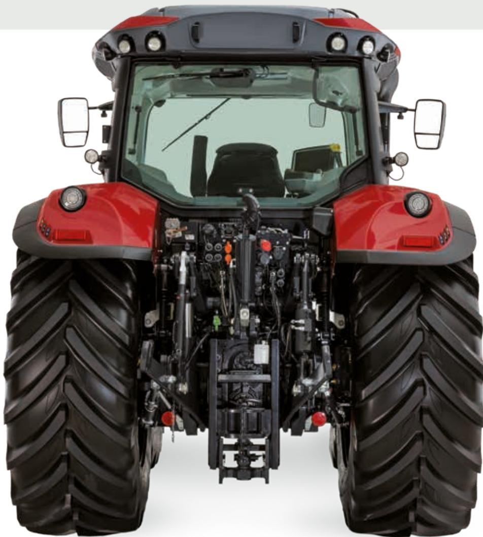
McCormick **X7 SWB** dispone di un impianto idraulico CCLS – Centro Chiuso Load Sensing, con pompa a portata variabile, per regolare il flusso dell'olio in funzione del carico. Questa tecnologia elimina ogni inutile assorbimento di potenza, per assicurare prestazioni sempre al top. Il circuito invia fino a 160 l/min al sollevatore e ai distributori, permettendo un uso simultaneo delle attrezzature idrauliche. La pompa dedicata allo sterzo ha una portata di 52 l/min.
