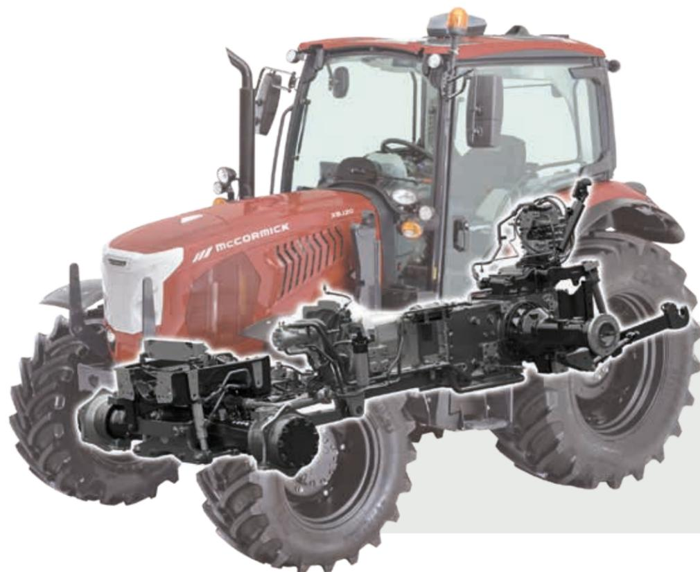
El X5 equipa un circuito hidráulico de centro abierto con una bomba doble de 62 l/min o triple de 82 l/min que alimenta los distribuidores, los elevadores y la pala. Una segunda bomba de 32 l/min acciona la dirección. Esta gran capacidad hidráulica permite:
