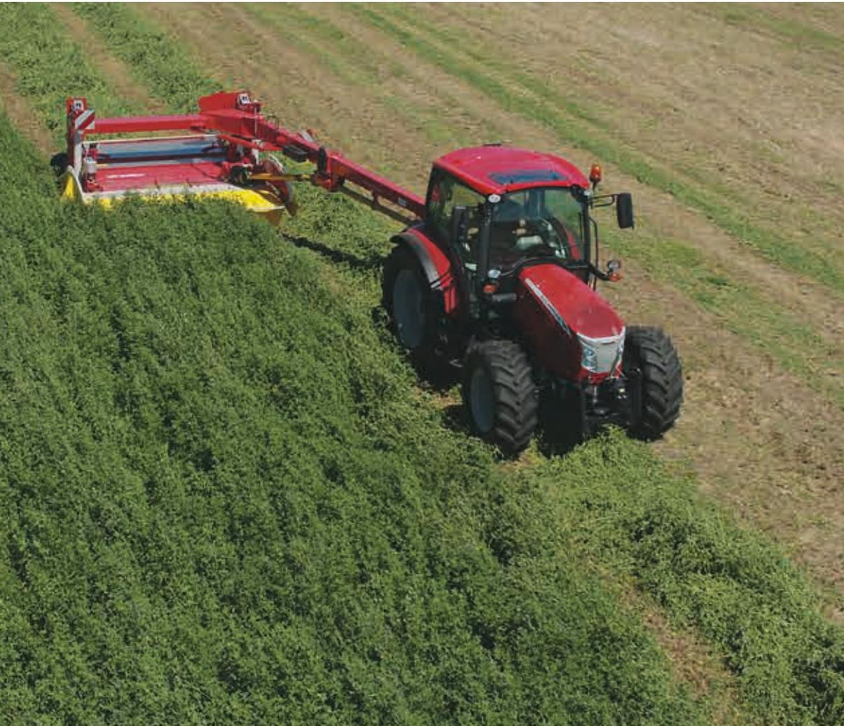
L'**X5.085** è come un trattore di categoria superiore, perché i suoi 75 CV sembrano almeno 10 CV in più. Il propulsore è un FPT F34, 3,4 litri, 4 cilindri e 8 valvole, Turbo Intercooler con iniezione elettronica Common Rail. La coppia da 375 Nm a 1.400 giri/min e la riserva di coppia del 56% sono veramente eccezionali: la potenza del motore è costante dai 1.400 ai 2.200 giri. Il serbatoio è stato portato a 103 litri, per una piena autonomia di lavoro.
