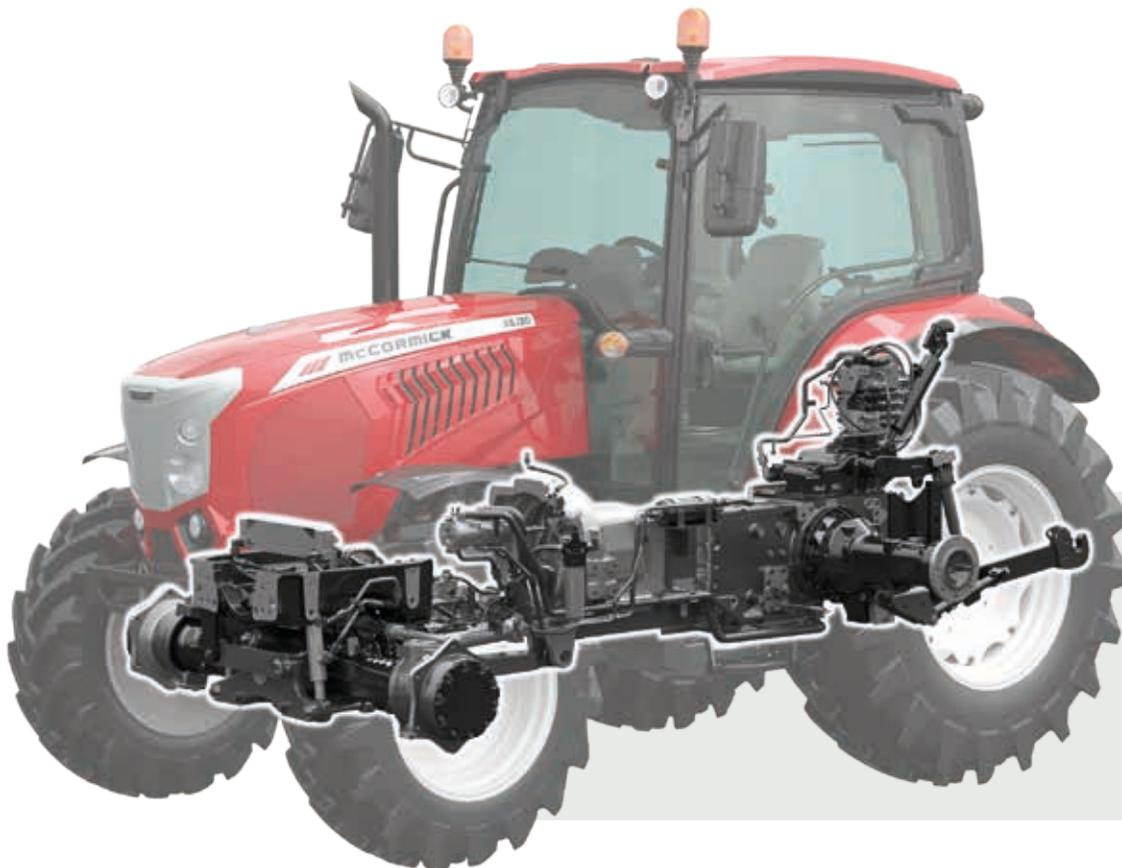
L'X5 è equipaggiato con un circuito idraulico a centro aperto con pompa da 62 l/min oppure 82 l/min, dedicata ai distributori, ai sollevatori e al caricatore. Una seconda pompa da 32 l/min è riservata allo sterzo. Questa potente capacità idraulica permette di:
