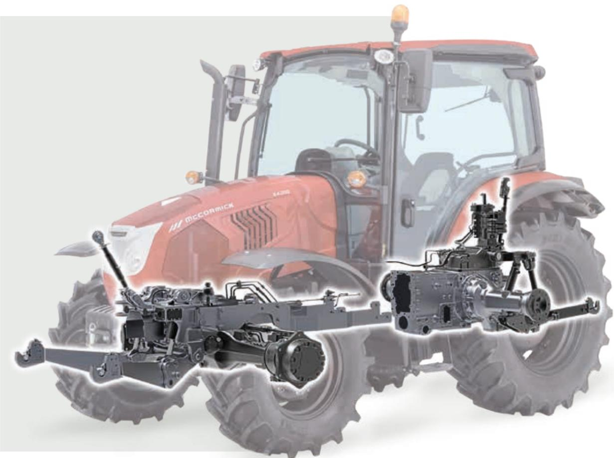
McCormick **X4** è equipaggiato con 2 pompe: quella dedicata allo sterzo, con portata di 30 l/min, consente di sterzare in modo agile e leggero anche in campo, per garantire più comfort e più produttività; la seconda pompa, dedicata ai servizi, ha una portata di 52 l/min.
