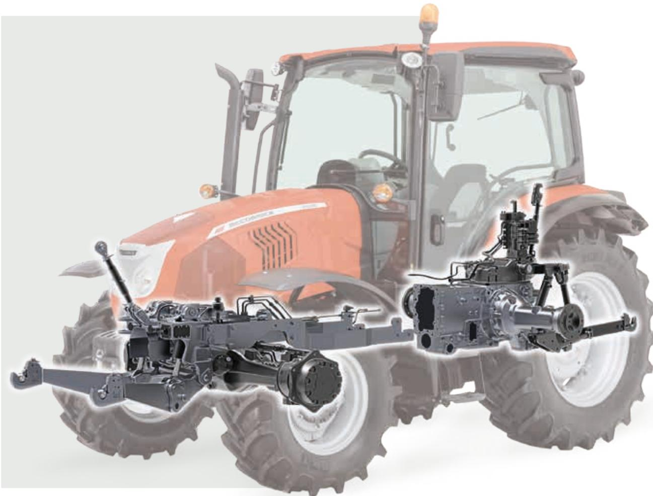
Le McCormick **X4** est équipé de 2 pompes : celle dédiée à la direction, avec un débit de 30 l/min, permet un braquage agile et léger même dans le champ, pour plus de confort et de productivité ; la seconde pompe, dédiée aux services, a un débit de 52 l/min.
