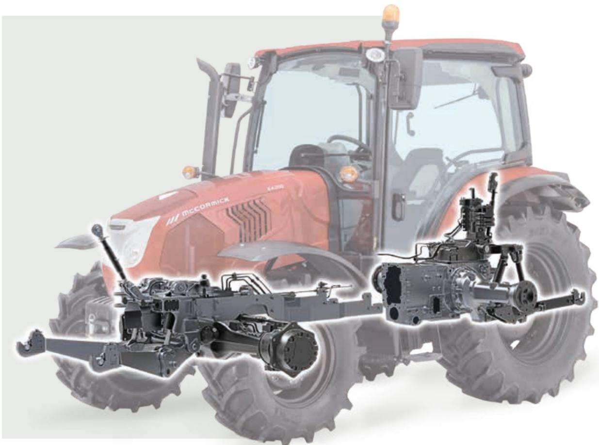
Le McCormick **X4** est équipé de 2 pompes : celle dédiée à la direction, avec un débit de 30 l/min, permet un braquage agile et léger même dans le champ, pour plus de confort et de productivité ; la seconde pompe, dédiée aux services, a un débit de 52 l/min.
