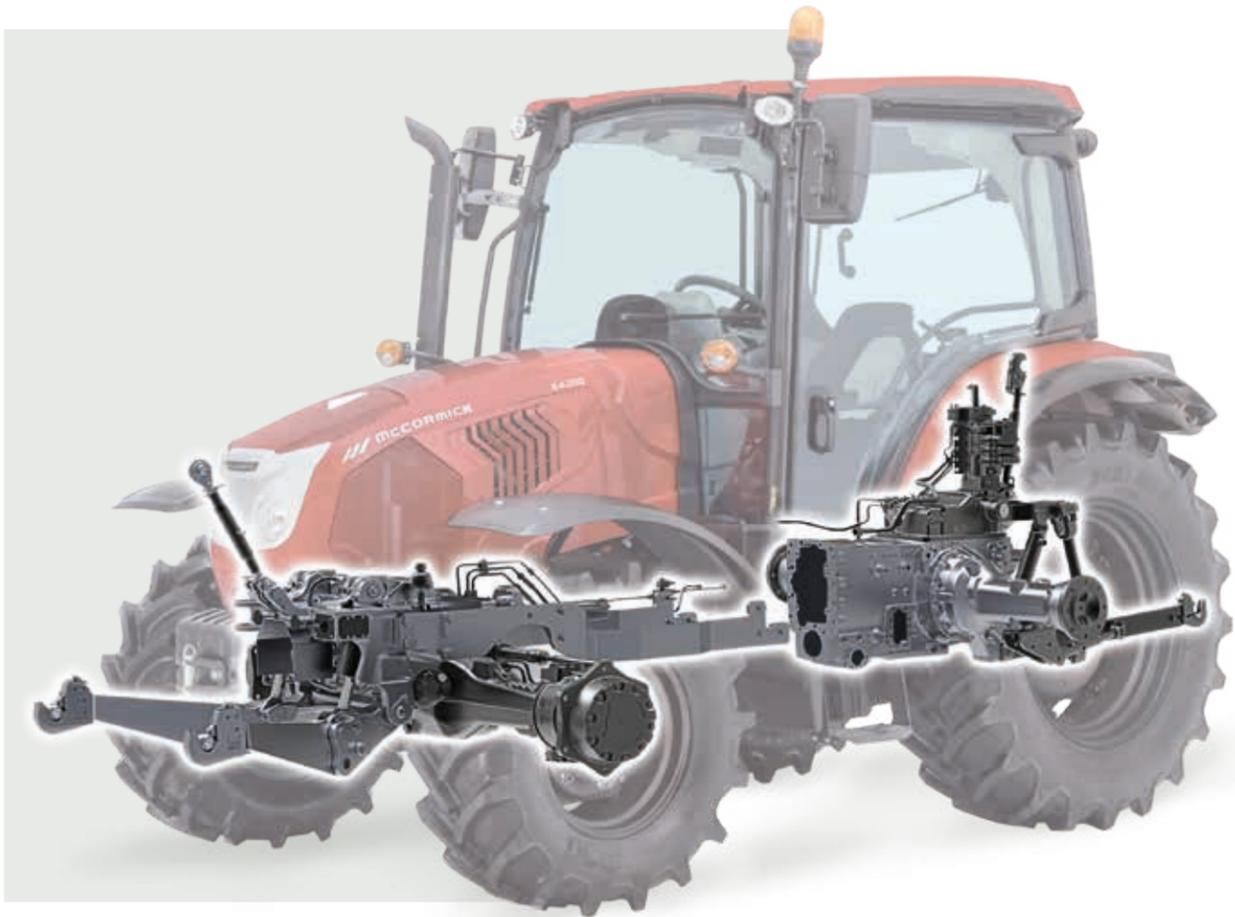
Das Hydrauliksystem des **X4** verfügt über zwei Pumpen, die eine Fördermenge von insgesamt 82 l/min gewährleisten. Eine Pumpe versorgt die Lenkung mit 30 l/min und ermöglicht sanftes und präzises Lenken unter allen Bedingungen für mehr Bedienkomfort und höhere Produktivität.
