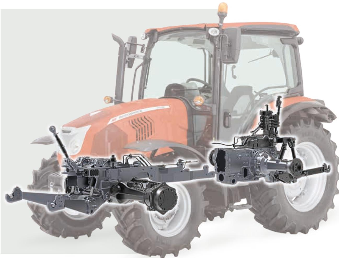
McCormick **X4** è equipaggiato con 2 pompe: quella dedicata allo sterzo, con portata di 30 l/min, consente di sterzare in modo agile e leggero anche in campo, per garantire più comfort e più produttività; la seconda pompa, dedicata ai servizi, ha una portata di 52 l/min.
