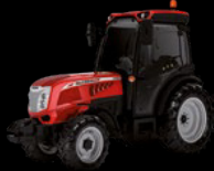
X4 V von 70 bis 102 PS Außenbreite ab 1003 mm
