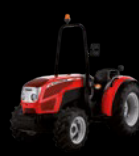
X3 F von 55 bis 75 PS Außenbreite ab 1358 mm
