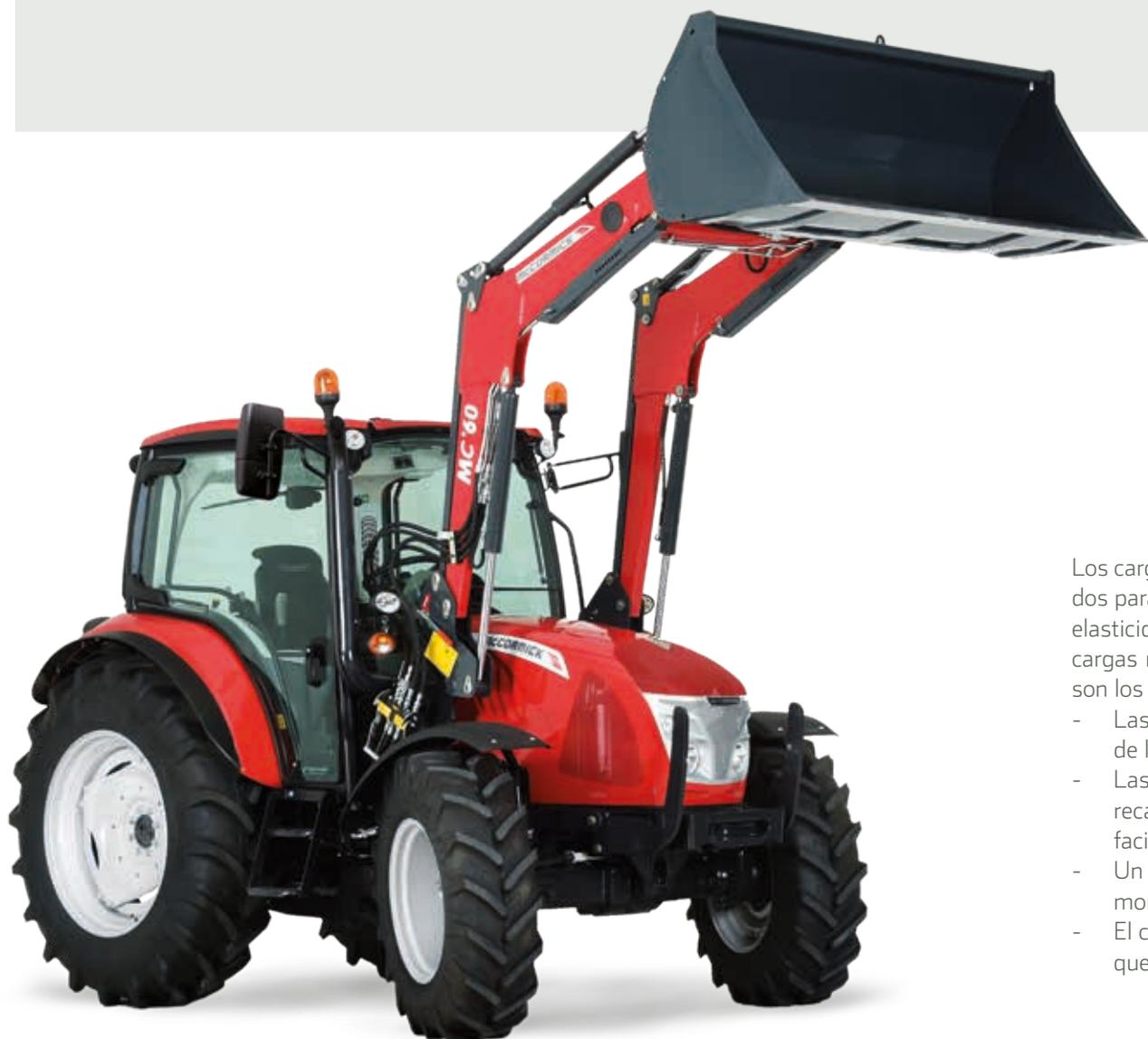
Los cargadores frontales McCormick M60 han sido específicamente diseñados para los tractores Serie X4. Están fabricados en acero con alto límite de elasticidad, un material con propiedades mecánicas que le permiten soportar cargas muy elevadas. Los puntos fuertes de los cargadores frontales M60 son los siguientes:
