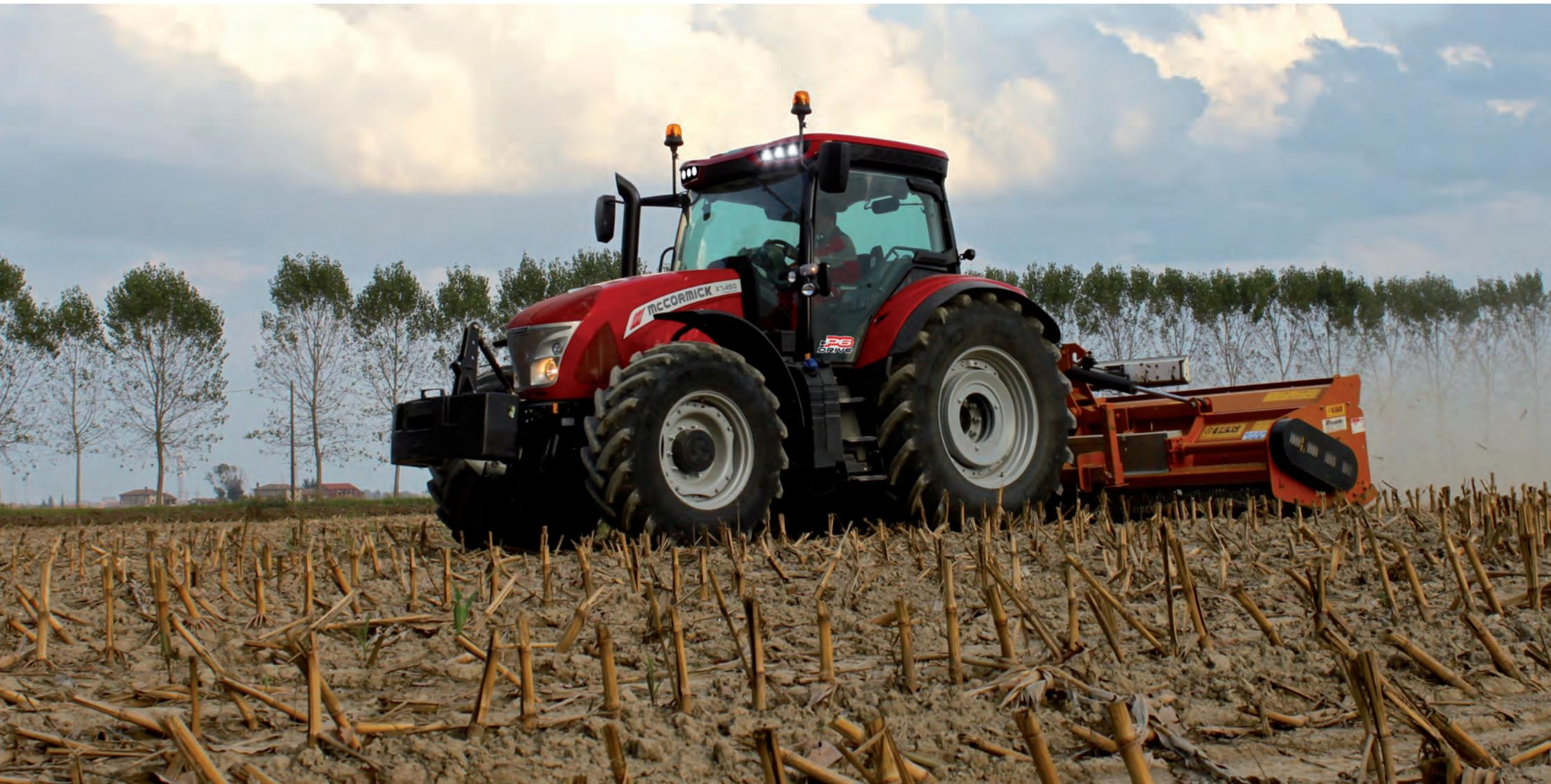
La Serie X7.4 di McCormick, è equipaggiata di motori Betapower Fuel Efficiency a 4 cilindri da 4,5 litri con emisionamento Stage 4/Tier 4 Final; il sistema di post-trattamento dei gas di scarico è dotato di SCR (Selective Catalyst Reduction) e DOC (Diesel Oxidation Catalyst).
