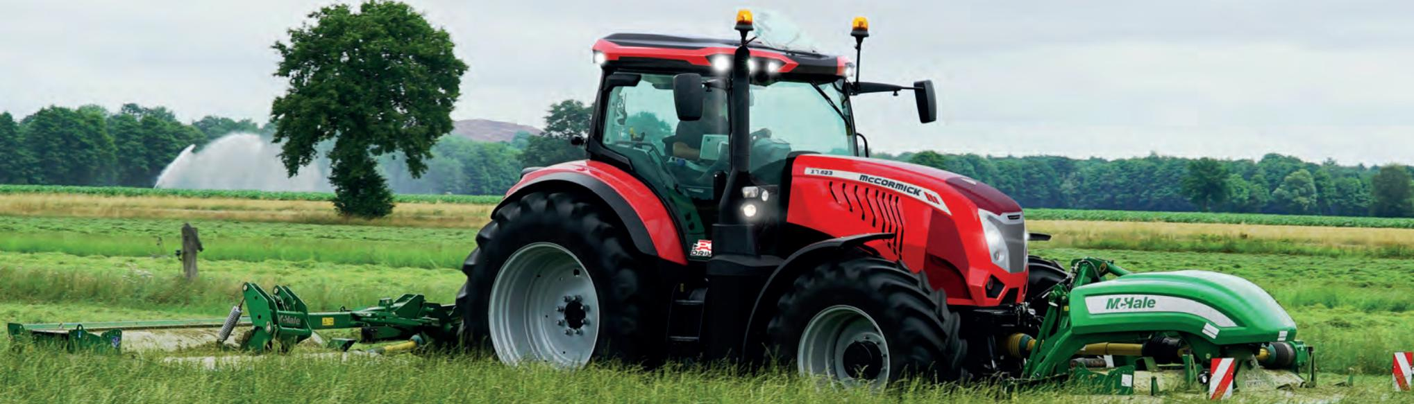
Il nuovo X7.6 P6-Drive di McCormick è caratterizzato da motori e nuovi sistemi di post-trattamento dei gas di scarico che rispondono allo standard Stage V e dal rinnovato design che si caratterizza dalla nuova linea del cofano che, seguendo le caratteristiche aggressive del marchio, è capace di garantire una visibilità massima per l'operatore, e dal tetto, con 12 nuovi fari da lavoro posizionati in modo da garantire l'illuminazione di lavoro a 360°.
