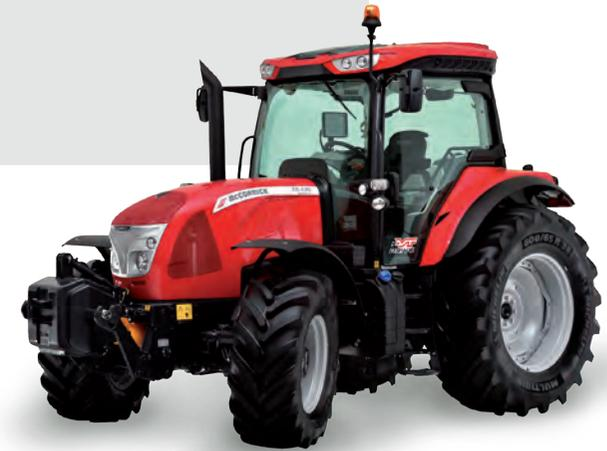
È disponibile in 3 modelli con potenze di 121CV, 133CV e 140CV garantite da motori a 4 cilindri Betapower Fuel Efficiency da 4.500 cm<sup>3</sup> emmissionati STAGE 4 / TIER 4 FINAL con sistema SCR + DOC di post trattamento dei gas e con una trasmissione VT-Drive di realizzazione Argo Tractors CVT (variazione continua a 3 stadi).
