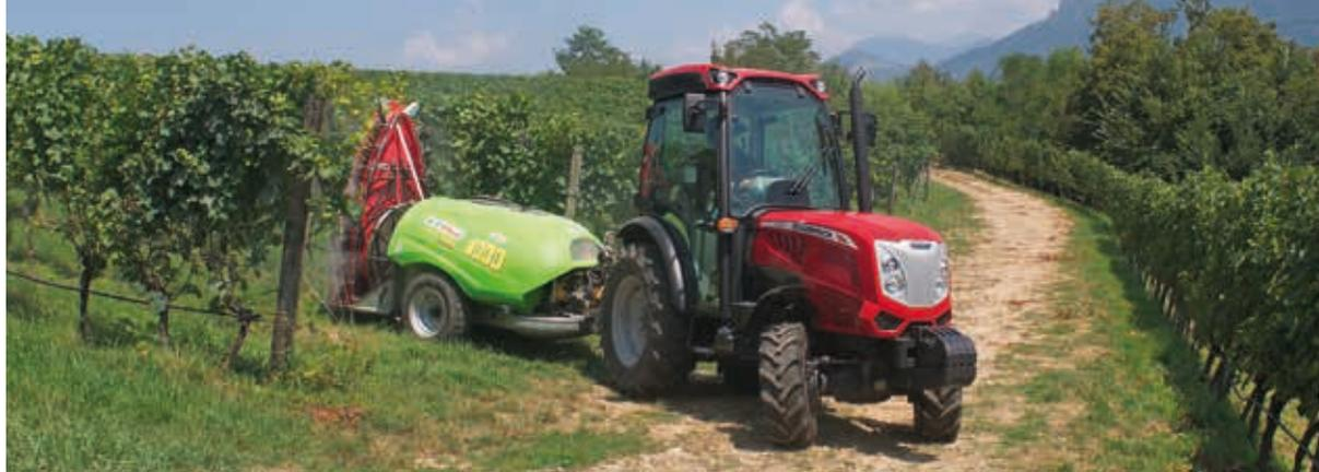
Il McCormick X4V è il nuovo specialista dei vigneti. È equipaggiato coi nuovi motori a 4 cilindri Deutz Stage 3B / Tier 4 Interim da 2,9 lt (TCD L4) che sono dotati dei sistemi di trattamento dei gas di scarico EGR + DOC e del dispositivo Engine Memo Switch per memorizzare il numero di giri del motore. Le potenze massime a 2.200 giri/min. dei 5 modelli partono da 70 CV per arrivare a 102 CV. Il serbatoio carburante da 80 lt. garantisce la massima autonomia di lavoro.
