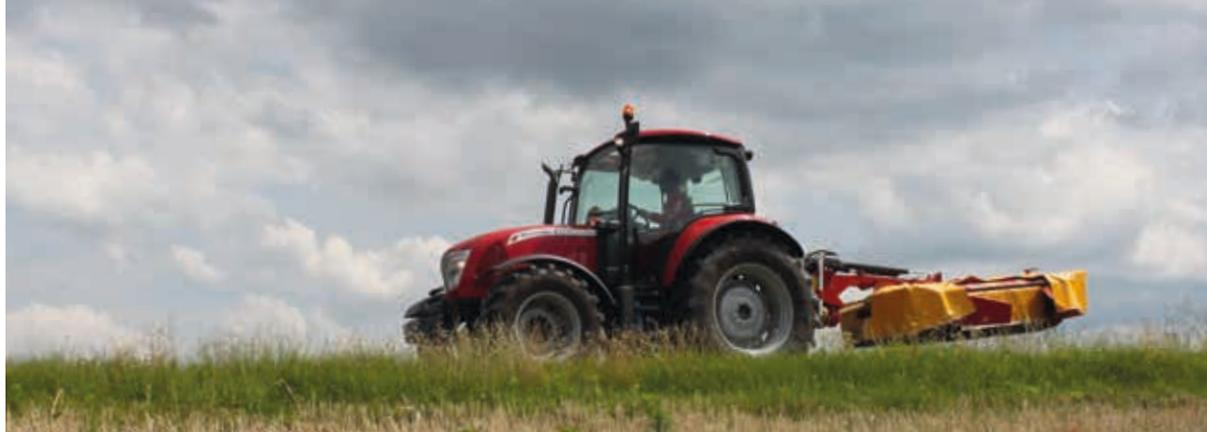
Unico distinguo il passo di 2.230 mm per i 3 modelli di alta potenza e di 2.100 mm per gli altri, determinato dall'architettura dei motori. L'estetica delle linee ripropone il Family Feeling delle tradizionali gamme McCormick.
