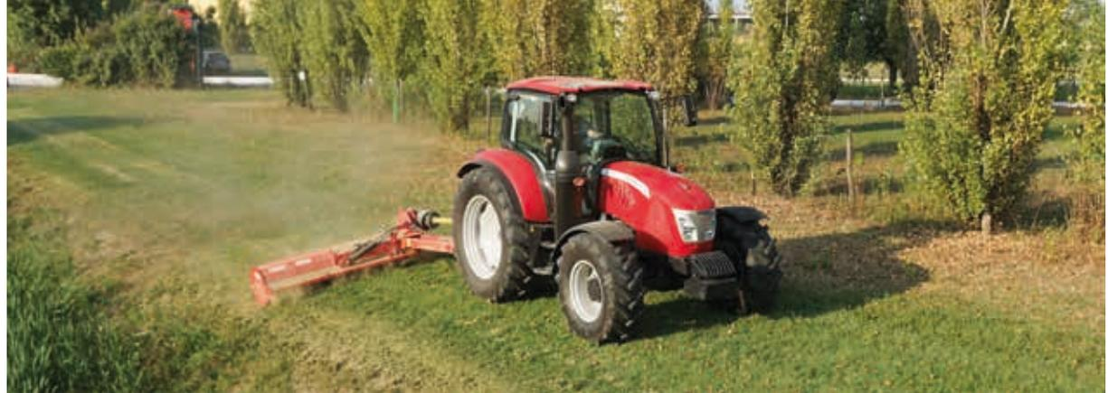
Der McCormick X6 ist mit einem Deutz Tier 4 Final Motor mit 3,6 Liter Hubraum ausgestattet.
