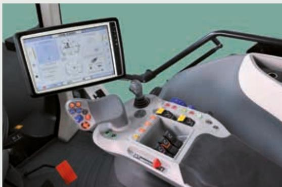
Cabine avec finition Premium : les commandes de la transmission VT-Drive sont intégrées à l'accoudoir du siège.
