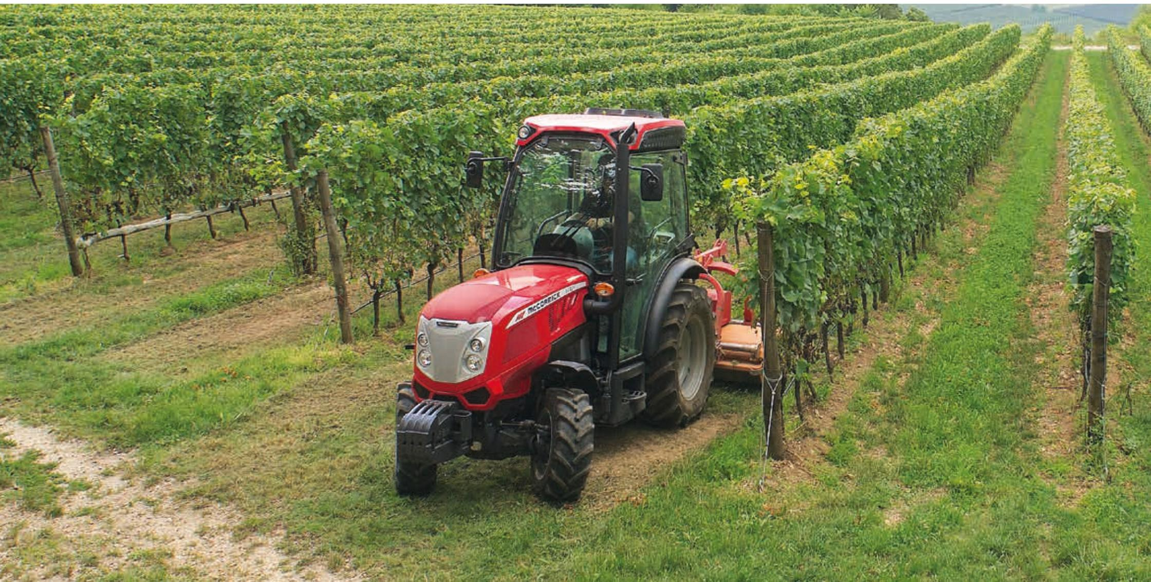
La série X4 V est la nouvelle gamme de tracteurs vignerons de McCormick. Les cinq modèles de la gamme sont animés par des moteurs Deutz TCD L4 à 4 cylindres de 2,9 litres conformes aux normes d'émissions Stage 3B / Tier 4 Interim qui fournissent des puissances maximales de 70 à 102 ch à 2200 tr/min. Tous les modèles sont équipés de système de recirculation des gaz d'échappement EGR et de catalyseur d'oxydation diesel DOC.
