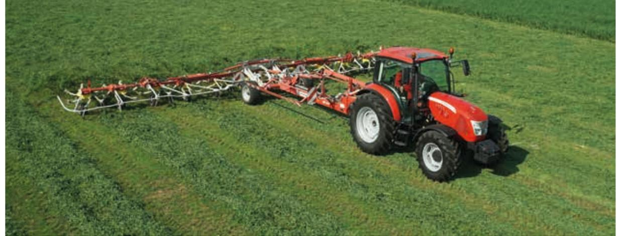
McCORMICK X5 Tier 4i : dans le segment "Medium Utility" et recevant l'homologation pour tracteur spécialisé, McCORMICK présente pour les marchés CEE la nouvelle série X5 animée par des moteurs Deutz de 3,6 litres Stage 3B / Tier 4 Interim avec seulement catalyseur DOC et sans SCR.
