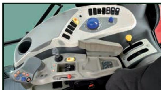
**Commandes du tracteur.** L'accoudoir multifonction où sont placées aussi les commandes de la transmission.
