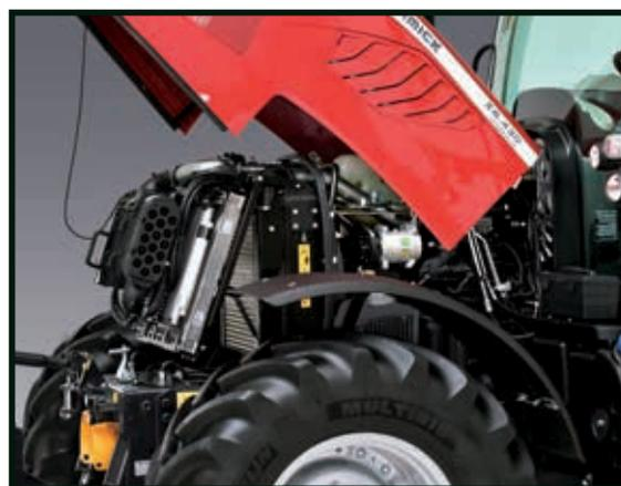
**Moteur.** Ouverture pivotante des radiateurs pour un nettoyage parfait.
