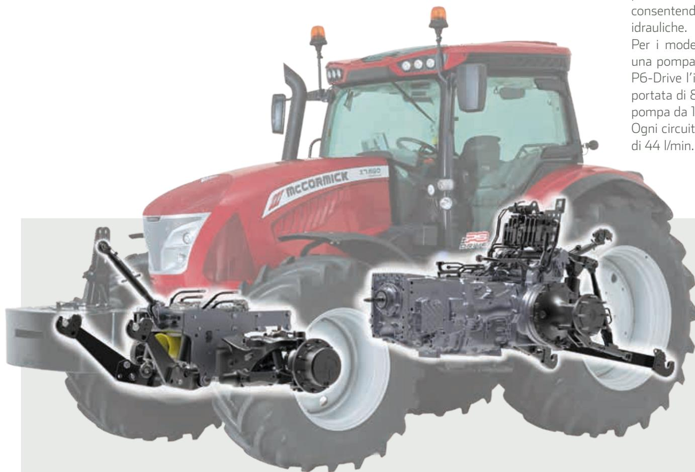
L'impianto idraulico della Serie X7 è a centro chiuso con pompa a portata variabile. Questo gli permette di regolare costantemente la disponibilità dell'olio in funzione della necessità, per evitare gli assorbimenti inutili di potenza. Il circuito invia fino a 123 l/min al sollevatore e ai distributori, consentendo così un utilizzo anche simultaneo di tutte le attrezzature idrauliche.
