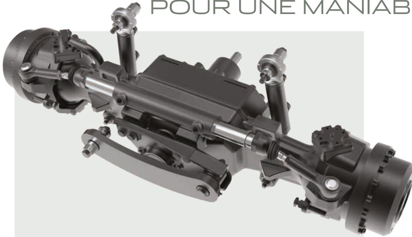
Les modèles F et XL avec cabine peuvent être équipés d'un pont avant avec suspension centrale au lieu de l'essieu rigide fourni de série. Cet essieu est doté de blocage du différentiel et de freins à disques humides, qui, en combinaison avec les freins arrière, garantissent un freinage efficace sur les quatre roues.
