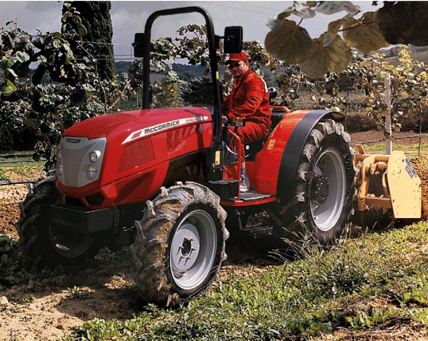
Per i modelli piattaforma, l'impianto idraulico è con pompa doppia da 50 + 28 l/min, per il sollevatore e lo sterzo. Su richiesta, è disponibile con pompa tripla da 41 + 41 + 28 l/min, per il sollevatore, i distributori e lo sterzo. Con la pompa tripla si possono richiedere 3 distributori ventrali anteriori, associati a un joystick per il controllo degli attrezzi montati frontalmente.
