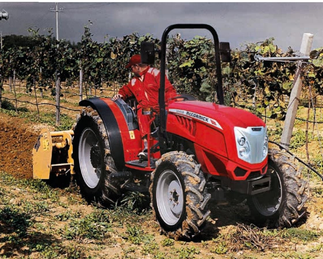
Sui modelli piattaforma è disponibile la trasmissione Speed Four, dotata di 4 marce e 3 gamme, per 12 AV + 12 RM, con inversore meccanico. In alternativa, si può scegliere la trasmissione Speed Five, a 5 marce e 3 gamme, per ottenere 15 AV + 15 RM, con inversore meccanico o idraulico. Alla trasmissione Speed Five si può aggiungere l'opzione Power Five e arrivare a 30 AV + 30 RM. A richiesta, in tutte le versioni è disponibile il Super Riduttore.
