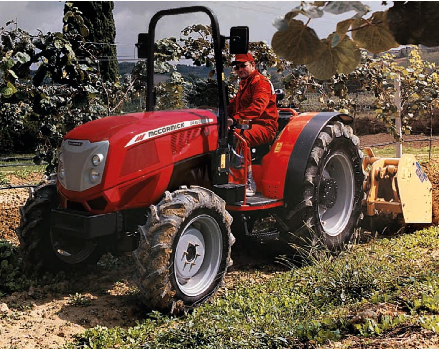
Bei den Plattformmodellen ist die Hydraulikanlage mit einer Doppelpumpe ausgestattet, die 50 l/min für den Heckkraftheber und 28 l/min für die Lenkung zur Verfügung stellt. Als Option ist eine Dreifachpumpe mit einer Förderleistung von 41+41+28 l/min für die Speisung von Kraftheber, Steuergeräten und Lenkung. Mit der Dreifachpumpe sind drei Zwischenachssteuergeräte an der Vorderseite und ein Joystick für die Bedienung von Front- und Zwischenachsbaugeräten erhältlich.
