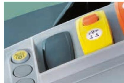
**MODULIERTER ANLAUF DER ZAPFWELLE FÜR MEHR KOMFORT**
