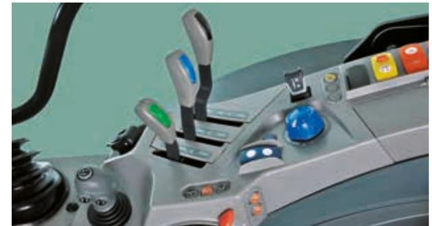
**EIN JOYSTICK ZUR STEUERUNG DER ARBEITSGERÄTE**
