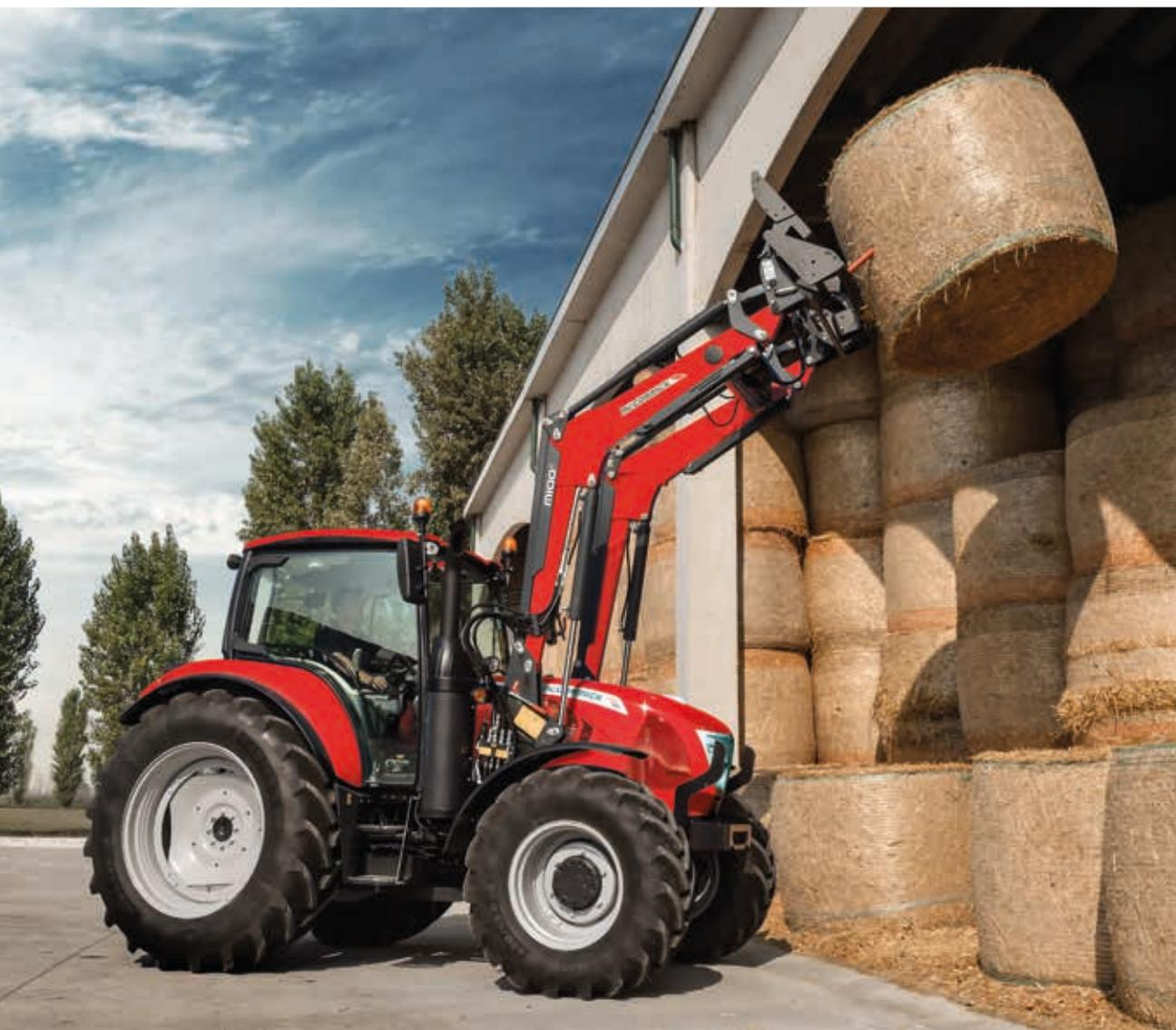
Les chargeurs frontaux McCormick M80 et M100 sont spécialement conçus pour être installés sur les tracteurs Série X6. Ils sont fabriqués en acier à haute limite d'élasticité, un matériau capable de résister à des charges très élevées grâce à ses propriétés mécaniques.
