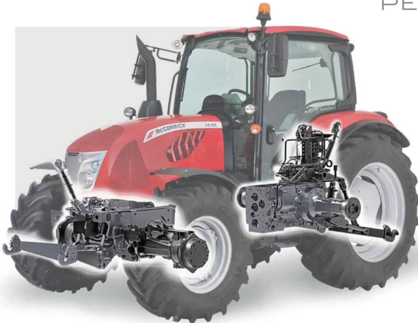
Le tracteur **X6** est équipé d'un système hydraulique à centre ouvert ayant un débit de 66 l/min qui permet de satisfaire toute exigence de travail. Un réservoir d'huile auxiliaire de 11 litres est disponible en option pour les outils nécessitant une grande quantité d'huile.
