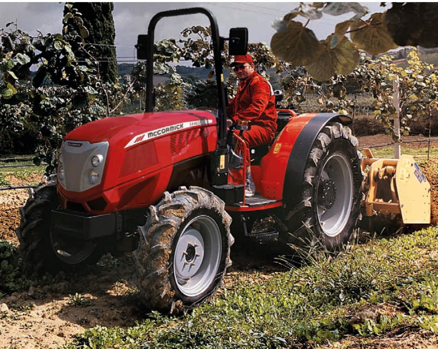
El circuito hidráulico del **X4F** plataforma equipa de serie una bomba doble que suministra 50+28 l/min para el elevador y la dirección. De forma opcional, está disponible una bomba triple con caudal de 41+41+28 l/min que alimenta el elevador, los distribuidores y la dirección. Tres distribuidores ventrales delanteros y un joystick que permite accionar aperos montados frontalmente están disponibles bajo pedido en combinación con la bomba triple.
