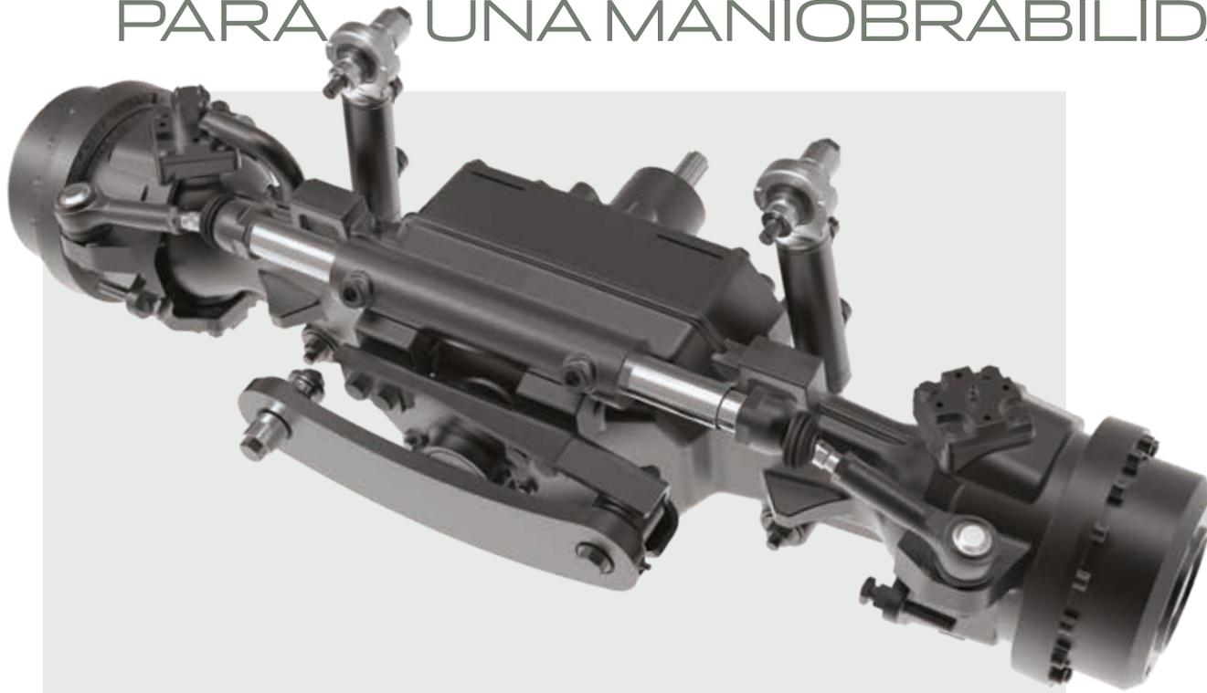
Además del eje rígido de serie, los modelos con cabina F, N y XL pueden equipar un puente delantero con suspensión central. El eje suspendido cuenta con bloqueo del diferencial y frenos de discos húmedos que, en combinación con los frenos traseros, proporcionan un frenado eficaz en las cuatro ruedas.
