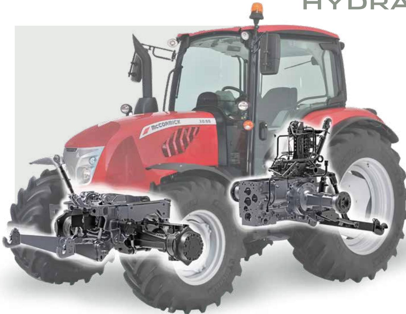
Die X6-Baureihe verfügt über einen offenen Hydraulikkreis mit einer Fördermenge von insgesamt 66 l/min, was den effizienten Betrieb aller Hydraulikfunktionen ermöglicht. Optional ist ein 11-Liter Reserve-Öltank für Anbaugeräte, die viel Öl benötigen erhältlich. Eine spezielle Pumpe versorgt das Lenksystem mit 30 l/min und sorgt für ein sanftes und präzises Wenden unter allen Bedingungen sowie für mehr Bedienkomfort und eine höhere Produktivität.
