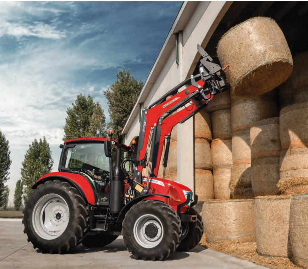
Die zusätzlich erhältlichen Frontlader McCormick M80 und M100 wurden für die einfache Anpassung in die Traktoren der Baureihe **X6** entwickelt und bestehen aus HLE-Stahl (High Limit Elasticity), einem Material, das aufgrund seiner Eigenschaften hohen Belastungen standhält.
