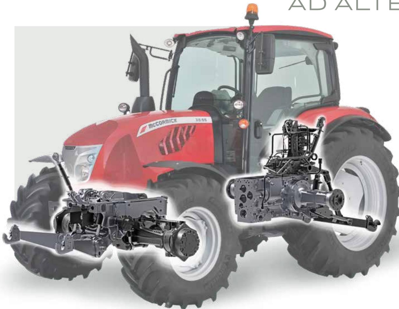
Il McCormick X6 è equipaggiato con un circuito idraulico a centro aperto capace di erogare 66 l/min, una portata che soddisfa la maggior parte delle esigenze di lavoro.
