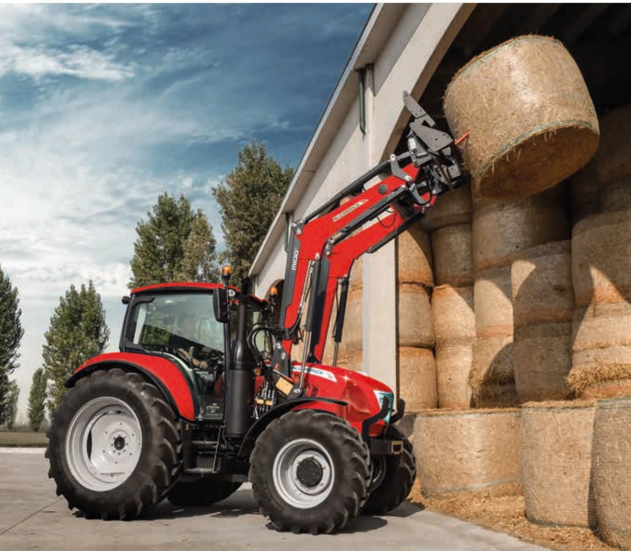
Progettati per essere integrati all'**X6**, i caricatori McCormick M80 e M100 sono realizzati in acciaio HLE ad alto limite elastico, capace di reggere carichi molto pesanti, grazie alle sue proprietà meccaniche. I punti di forza delle Serie M80 e M100:
