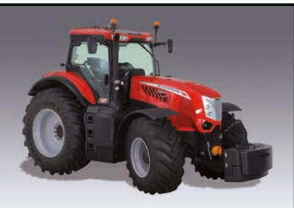
El X8 se entrega de serie con un elevador delantero capaz de levantar hasta 5000 kg y puede equiparse, de forma opcional, con una toma de fuerza de 1000 rpm. El puente delantero equipado con una suspensión central de control electrónico y cuenta con frenos de discos en baño de aceite que proporcionan un frenado eficaz para la máxima seguridad de conducción.
