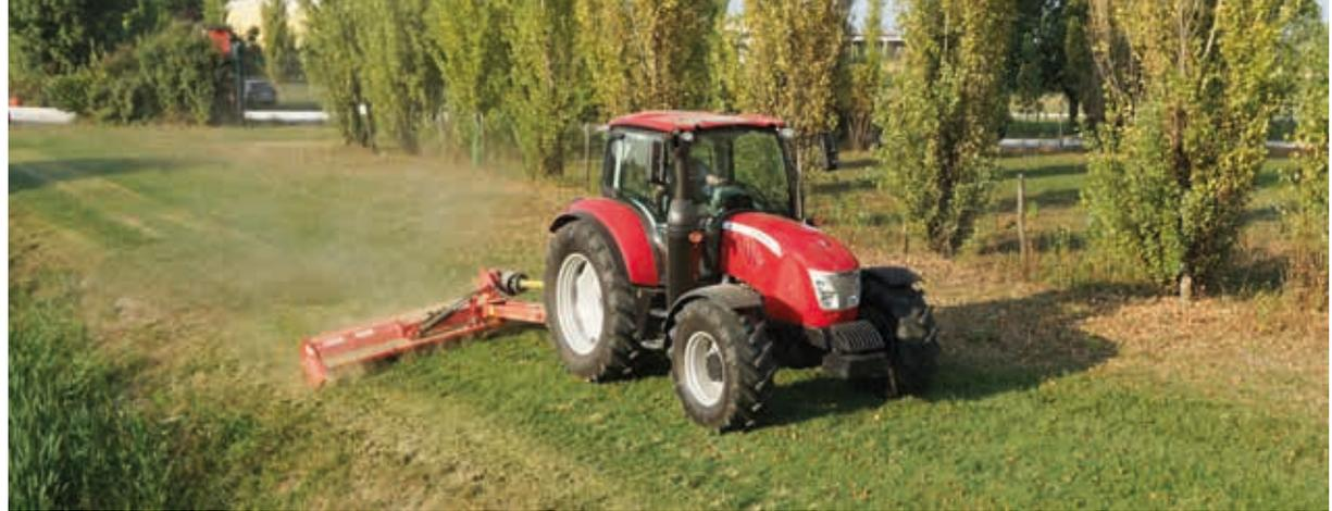
El McCormick X6 con motor Deutz Tier 4 Final de 3,6 litros es el heredero del exitoso X5. La Serie X6 consta de tres modelos, el X6.35, el X6.45 y el X6.55 con potencias máximas respectivamente de 110, 119 y 126 CV. La gama ofrece dos opciones de transmisión con inversor hidráulico: Speed Four 12/12 y Xtrashift 36/12 con HML. Para esta gama se ha aumentado el tamaño máximo de los neumáticos traseros de 34" a 38".
