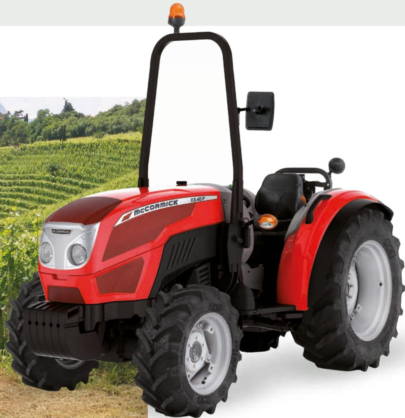
La nueva serie X3 F consta de tres modelos equipados con motores Kohler de 4 cilindros con 2,5 litros de cilindrada y 16 válvulas que desarrollan potencias de 55 a 75 CV. Los nuevos motores utilizan un catalizador de oxidación DOC para cumplir las normas de emisiones Stage 3B/Tier 4 Interim, eliminando así el proceso de regeneración de los gases de escape y la necesidad de un filtro de partículas diesel DPF.
