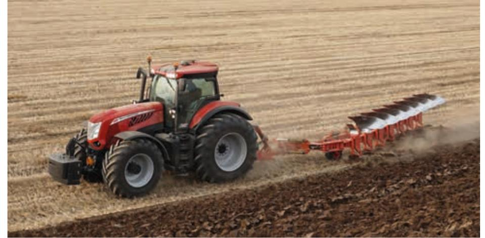
El X8 se entrega de serie con un elevador delantero capaz de levantar hasta 5000 kg y puede equiparse, de forma opcional, con una toma de fuerza de 1000 rpm. El puente delantero equipa una suspensión central de control electrónico y cuenta con frenos de discos en baño de aceite que proporcionan un frenado eficaz para la máxima seguridad de conducción.
