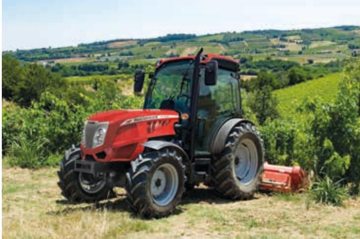
capacidad de elevación máxima de 3400 kg y puede contar con hasta tres distribuidores mecánicos y/o hasta siete distribuidores electrohidráulicos. Además puede equiparse de forma opcional con distribuidores ventrales, una válvula selectora y un difusor de flujo.
