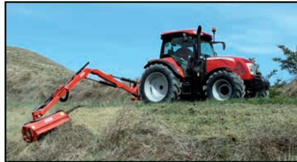
Quanto a contenuti tecnologici, la nuova gamma McCormick è dotata di nuova trasmissione *Xtrashift 36 + 12 (3 marce Powershift)* di un sollevatore posteriore sempre a controllo elettronico con capacità di 5400 kg, di una P.T.O. a 4 velocità (in opzione) e di un circuito idraulico nettamente migliorato con capacità di 66 litri/minuto nella versione standard e di 110 l/min. nella versione a centro chiuso (LS).
