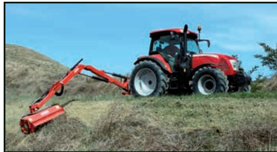
Côté technique, la Série X6 comporte une nouvelle transmission Xtrashift 36/12 (3 vitesses Powershift), un relevage arrière à commande électronique ayant une capacité de levage de 5400 kg et une prise de force à 4 vitesses optionnelle. Le circuit hydraulique, qui a été optimisé pour offrir de meilleures performances, est disponible en version standard avec un débit de 66 l/min ou en version à centre fermé (LS) avec un débit de 110 l/min.
