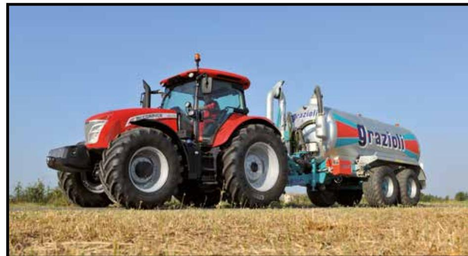
En option, il peut être équipé d'un inverseur hydraulique et d'une transmission Powershift à 3 vitesses. Le super-réducteur, disponible sur demande, permet une vitesse minimale de 410 m/h.
