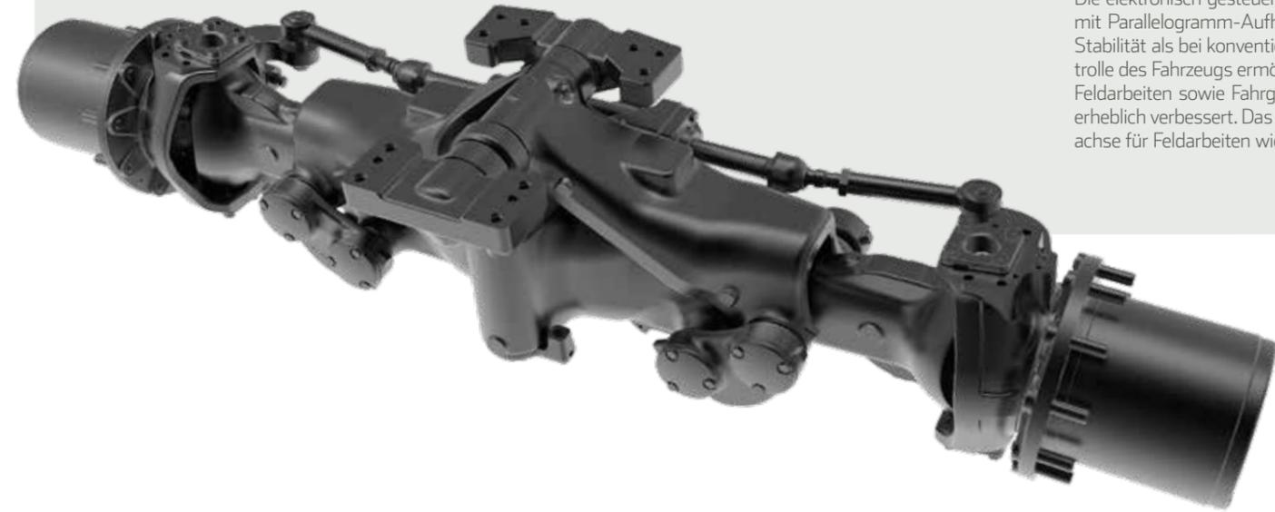
**VORDERACHSE MIT PARALLELOGRAMM-AUFHÄNGUNG FÜR VERBESSERTE LEISTUNG**
