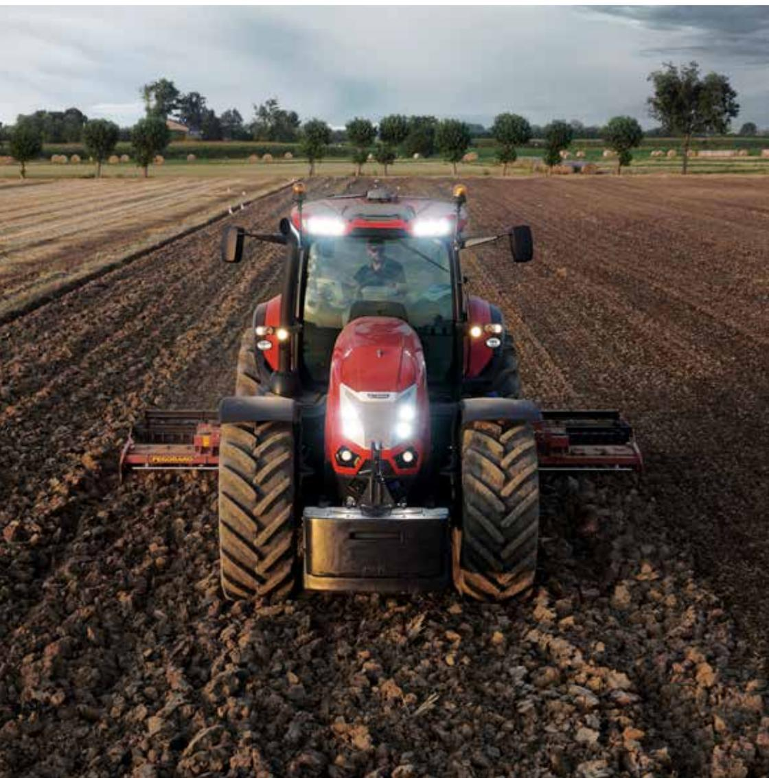
Le système de guidage par satellite, disponible en option, maximise l'efficacité de chaque travail en augmentant la rentabilité de votre tracteur. Le système est contrôlé à l'aide d'un écran tactile de 8,4" associé à une antenne satellite installée sur le toit de la cabine du tracteur. L'écran permet de gérer deux fonctions :
