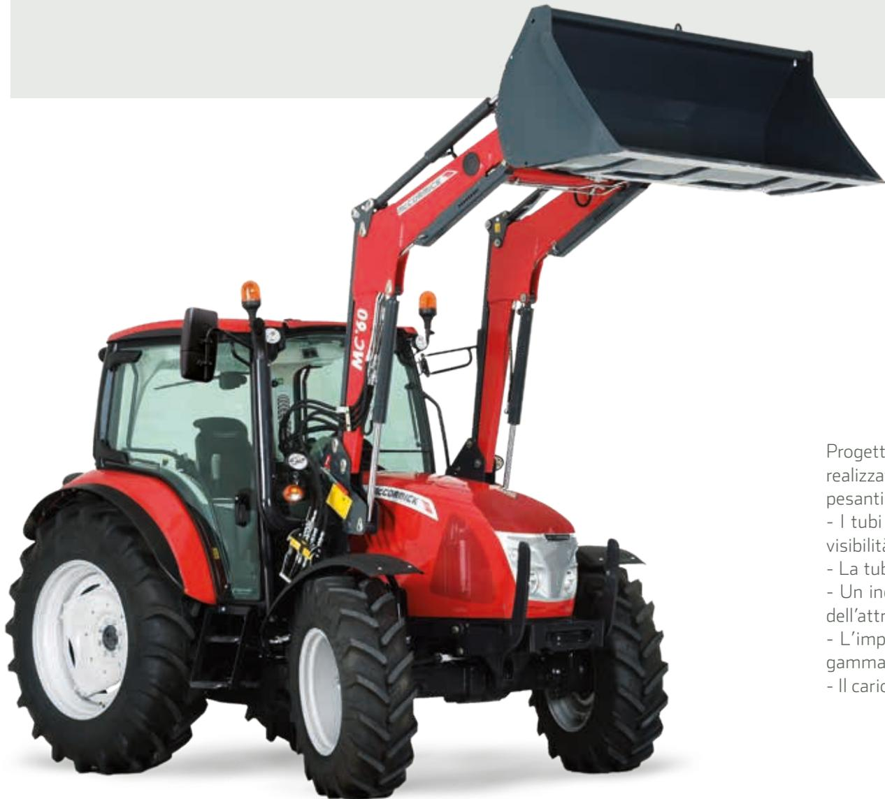
Progettati per equipaggiare il McCormick X4, i caricatori M60 e M80 sono realizzati in acciaio HLE ad alto limite elastico, per reggere carichi molto pesanti. I punti di forza principali:
