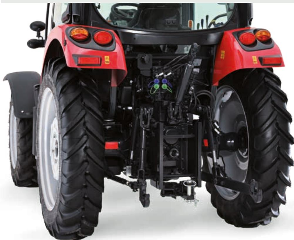
Grazie alla sua grande versatilità, McCormick X4 viene configurato a misura delle specifiche esigenze di lavoro di ogni azienda agricola. L'X4 può montare al tempo stesso il sollevatore posteriore, a comando meccanico o elettronico, e il sollevatore con presa di forza frontale o il caricatore frontale, per una produttività senza confronti.
