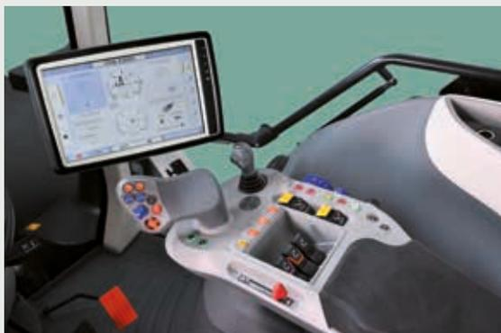
Cabina con allestimento Premium: i comandi della trasmissione VT-Drive sono posti sul bracciolo del sedile.
