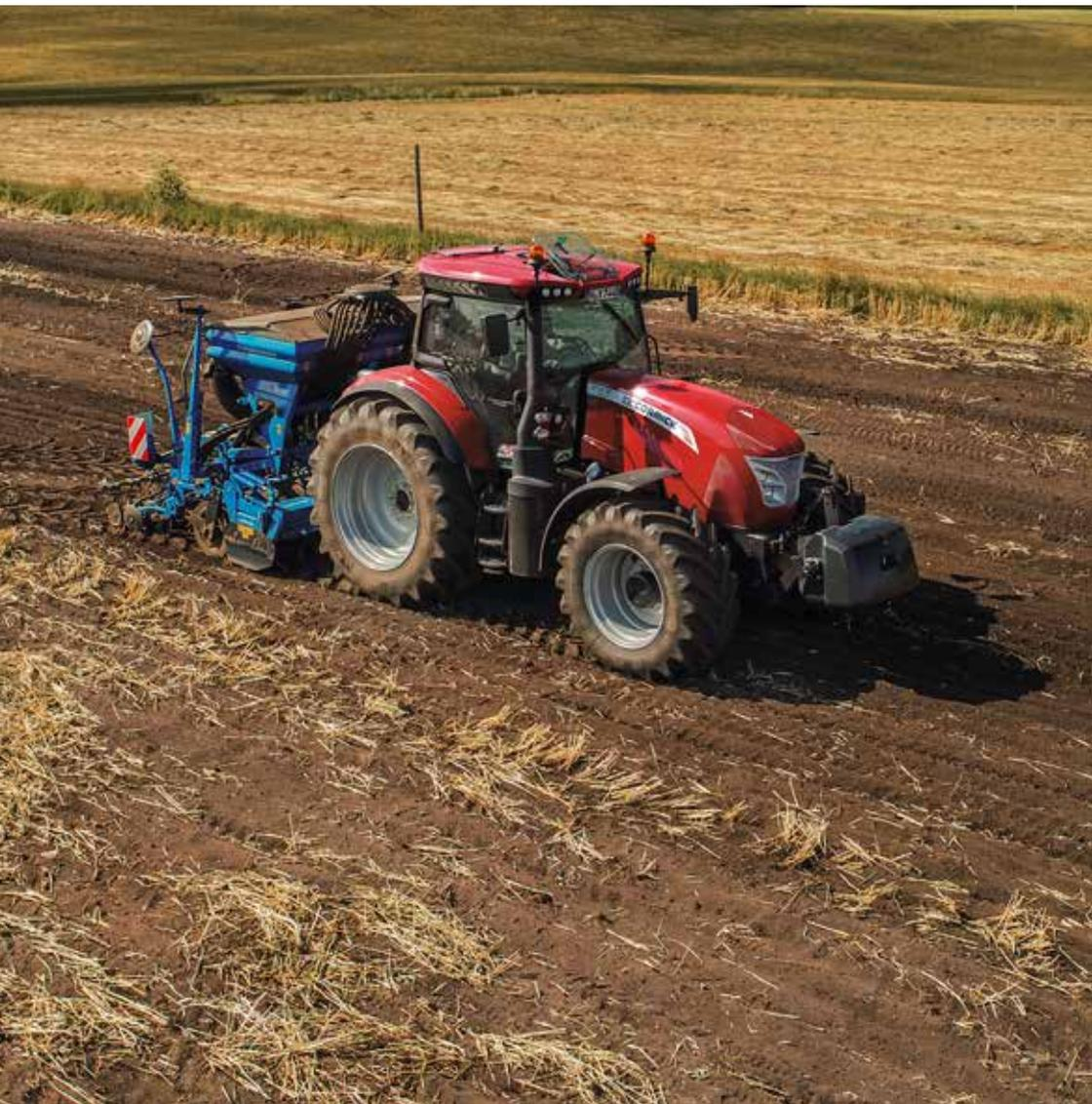
Il sistema di guida satellitare, disponibile a richiesta, si gestisce tramite il display touch screen da 8,4", che lavora in combinazione con l'antenna satellitare, posta sul tetto della cabina. Gli impieghi sono due:
