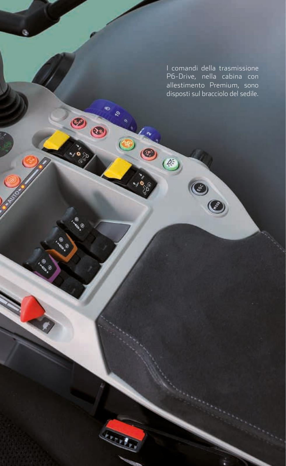
I comandi della trasmissione P6-Drive, nella cabina con allestimento Premium, sono disposti sul bracciolo del sedile.
