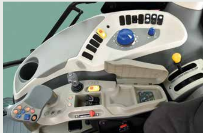
L'interno cabina del McCormick X6 allestimento con cambio VT-Drive : i comandi del trattore sono posizionati a destra del conducente sul bracciolo multifunzione del sedile.
