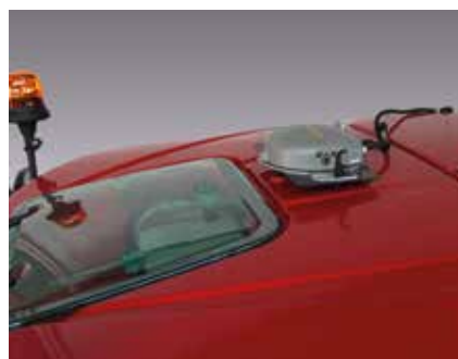
L'antenna satellitare posta sul tetto della cabina che riceve il segnale GPS.
