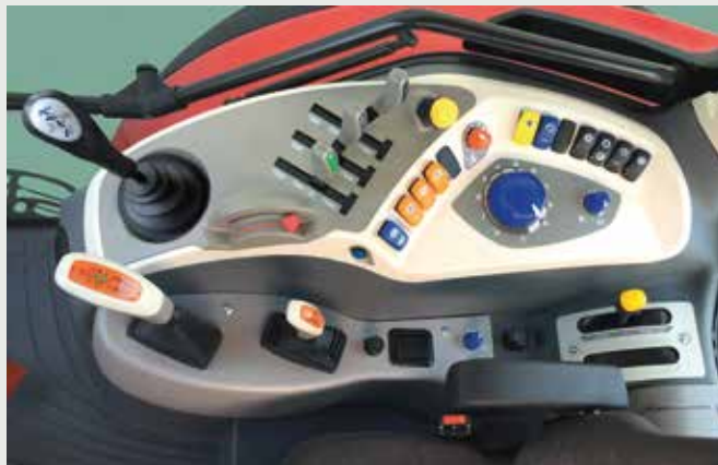
L'interno cabina del McCormick X6 allestimento con cambio Xtrashift i comandi del trattore sono posizionati a destra del conducente sulla consolle.
