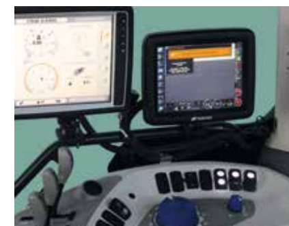
Il monitor touch screen di 8.4" dedicato alla gestione della guida satellitare e del sistema Isobus per le attrezzature.
