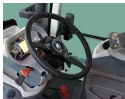
Il volante elettronico che permette una gestione precisa dello sterzo nelle lavorazioni in campo aperto con un errore massimo di 2 cm.
