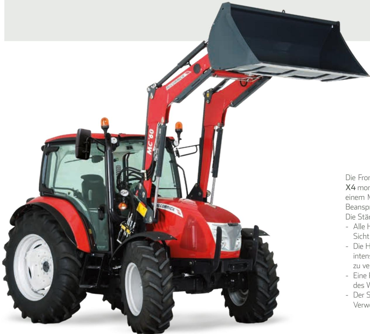
Die Frontlader McCormick M60 sind speziell entwickelt, um an die Traktoren **X4** montiert werden. Sie sind aus HLE-Stahl (hohe Elastizitätsgrenze) gebaut, einem Material, das aufgrund seiner mechanischen Eigenschaften extremen Beanspruchungen standhält.
