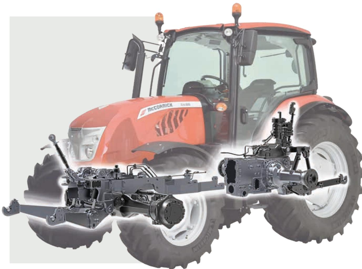
Das Hydrauliksystem des **X4** verfügt über zwei Pumpen, die eine Fördermenge von insgesamt 76 l/min gewährleisten. Eine Pumpe versorgt die Lenkung mit 32 l/min und ermöglicht sanftes und präzises Lenken unter allen Bedingungen für mehr Bedienkomfort und höhere Produktivität.
