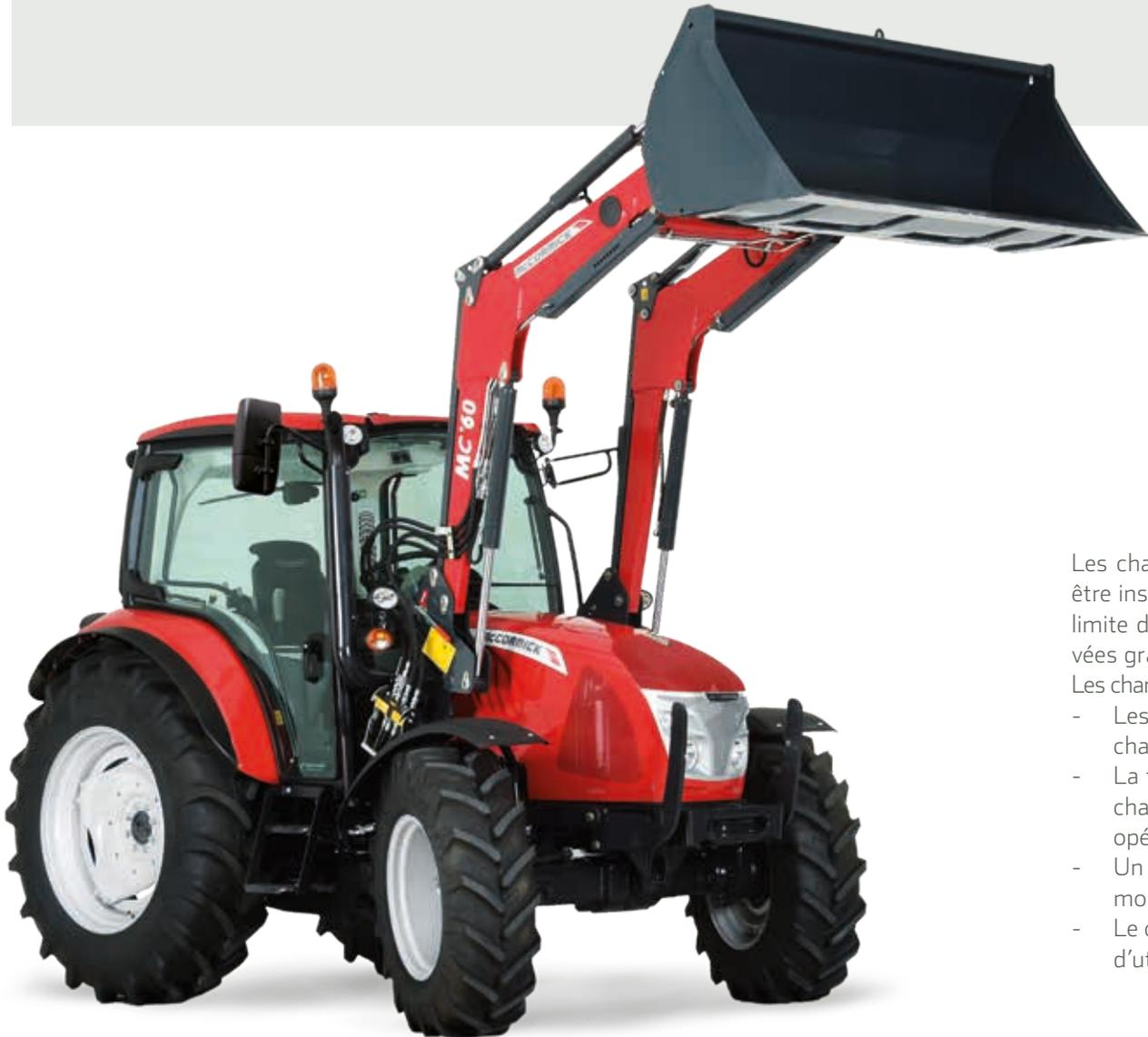
Les chargeurs frontaux McCormick M60 sont spécialement conçus pour être installés sur les tracteurs Série X4. Ils sont fabriqués en acier à haute limite d'élasticité, un matériau capable de résister à des charges très élevées grâce à ses propriétés mécaniques.
